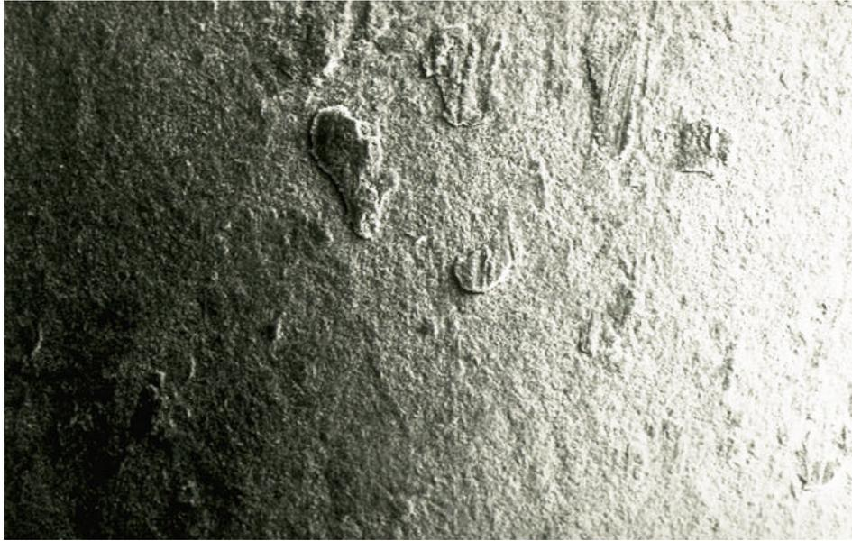
Abb. 46: Rauhe, der Bohrlochsohle zugewandte Oberfläche eines Randstifts (in Drehrichtung, also „Luv-Seite“) mit Schrammrillen und schalenförmig abplatzenden Hartmetallschüppchen. Immer wieder sind Rillen zu sehen, die rampenförmig beginnen und an deren stufenförmigen Ende kleine Schüppchen herausgerissen sind. Vergrößerung ca. 330 x, untere Bildkante 400  $\mu\text{m}$ .
