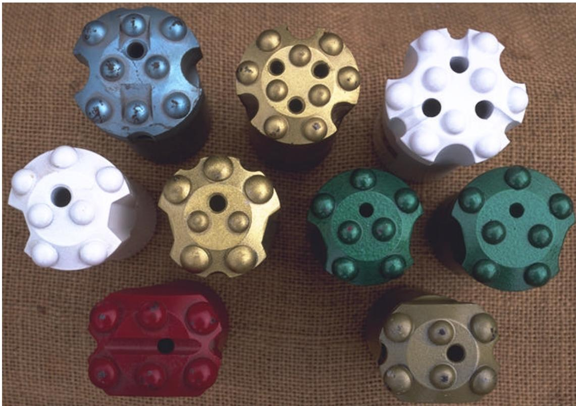
Abb. 8: Stiftbohrkronen verschiedener Hersteller (Atlas Copco, Böhler, Krupp, Minrock,) mit unterschiedlichen Stifanzahlen und Spülsystemen, die in überwiegend harten Gesteinen eingesetzt werden. Obere Reihe: 8- und 9-Stifttypen; mittlere Reihe: 7-Stifttypen; untere Reihe: ältere 6-Stifttypen.
