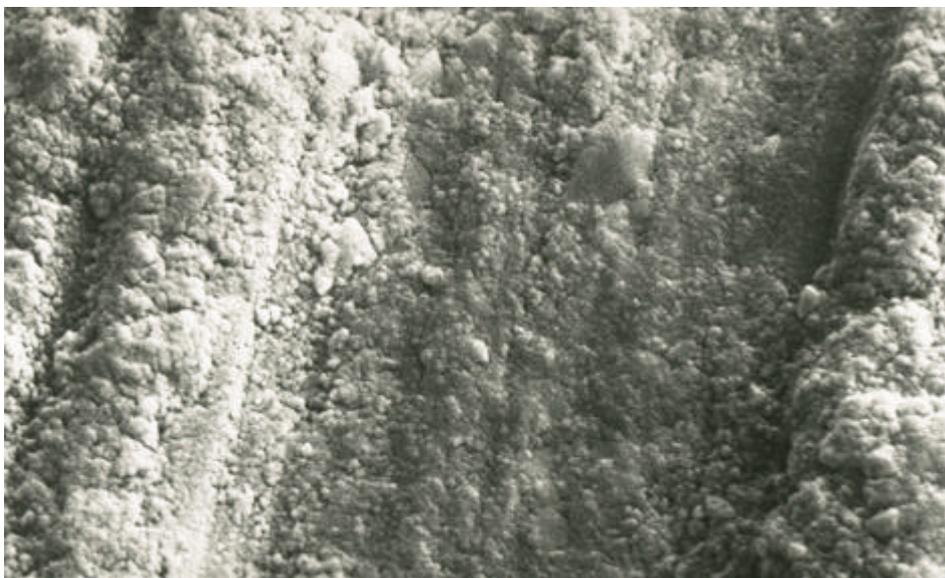
Abb. 48: Detail aus Abb. 46 in 2.700facher Vergrößerung. Deutlich ist die plastische Deformation des Hartmetalls an den seitlichen Stauchwällen der Rille zu sehen. Die Hartmetalloberfläche ist wesentlich weniger rauh im Vergleich zu Abb. 47 (bei gleicher Vergrößerung!). Untere Bildkante 50  $\mu\text{m}$ .
