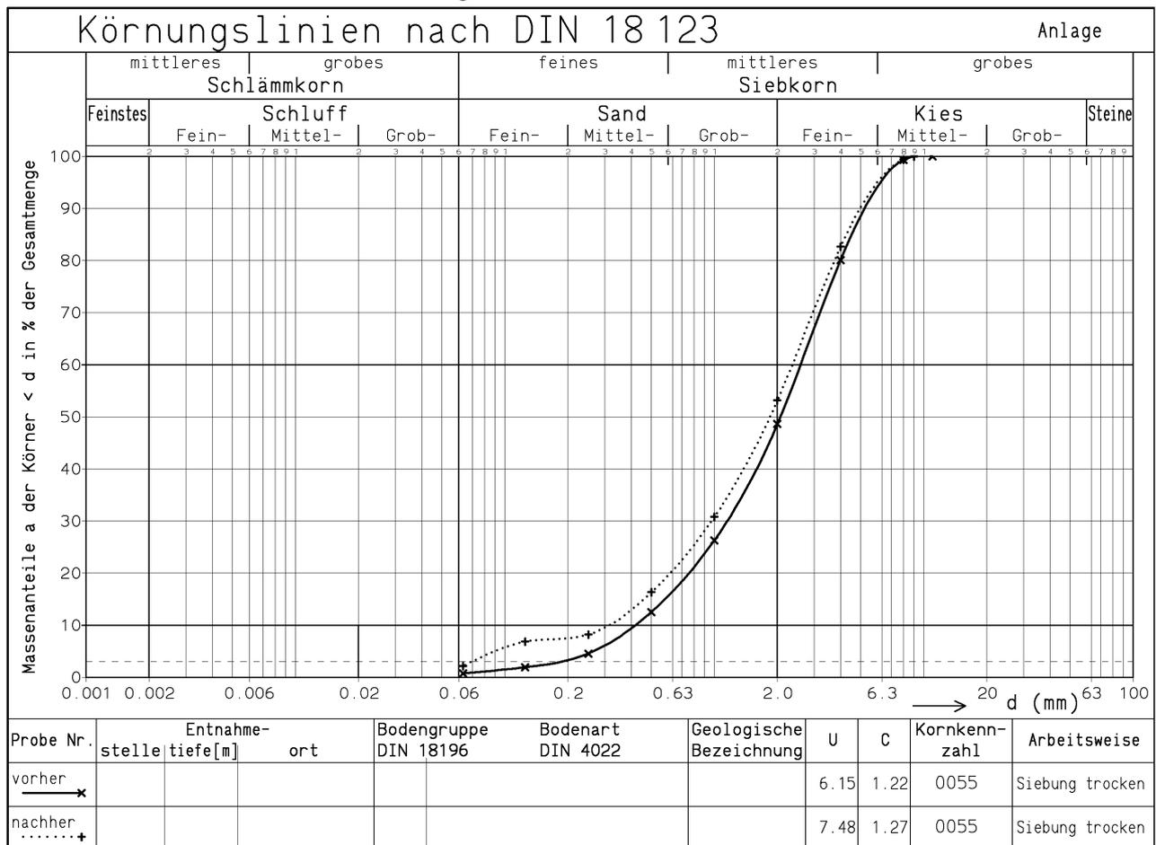
Abb. 44: Vergleich der Korngrößenverteilung der HMV-Schlacke vor und nach dem Kompressionsversuch
