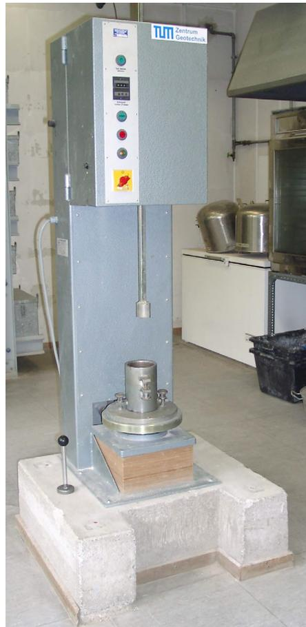
Abb. 42: Ermittlung der Proctordichte gemäß DIN 18127 mittels motorbetriebenem Verdichtungsgerät
