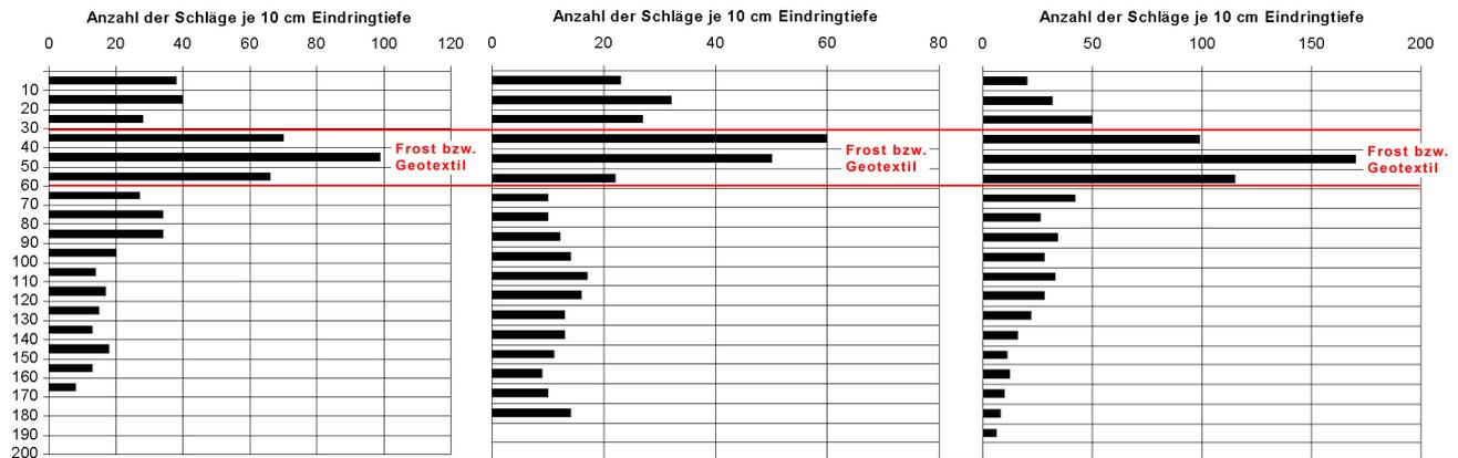
Abb. 26: Zusammenstellung der leichten Rammsondierungen der Baumaßnahme B
