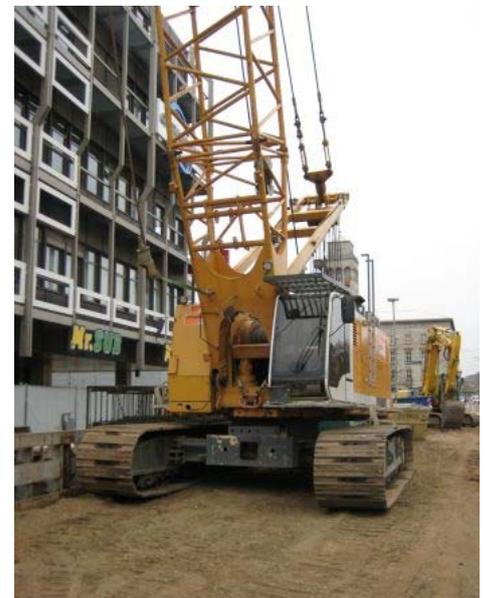
Bild 4: Seilbagger für Schlitzwandgreifer
