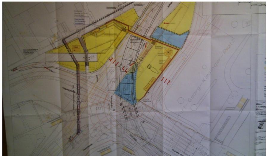
Bild 9: Aufwändige temporäre Verlegung der Kreuzung zur Erstellung einer Baugrube um den U-Bahn Tunnel in Trog-Bauweise zu erstellen. Nach Erstellung der Baugrube wird diese gedeckelt und der Verkehr zurückverlegt
