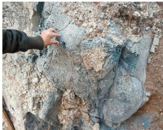
Bild 2: Verfestigtes Verpressmaterial
