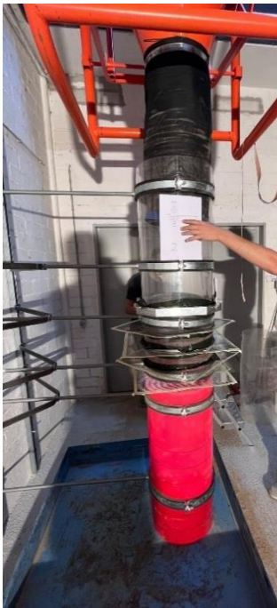
Abbildung 1: Versuchsaufbau zur Herstellung einer Probe im Sandrieselverfahren am Zentrum Geotechnik der TU München (linkes Foto); Auswertung von Messergebnissen gewonnen mit dem 2D-Laserprofilscanner zur Bestimmung von Kontrollvolumen für die Ermittlung der räumlichen Verteilung der Lagerungsdichte innerhalb der Probe (rechtes Diagramm)
