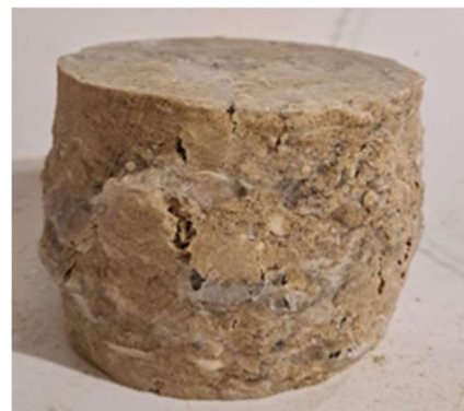
Ausführung einer Bodenvereisung im Tunnelbau (links) und gefrorene Probe aus Münchner Kies (rechts)
