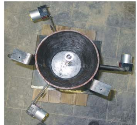
Draufsicht auf den Versuchsbehälter mit eingestelltem Modellknickstab und den drei Seilzugwegaufnehmern the top view of the small scaled test device, showing the centered model pile and the three wire displacement sensors
