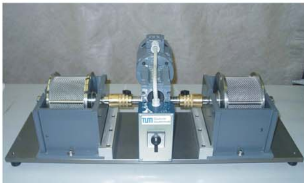
Versuchsgerät, Siebtrommelversuch Slake Durability Equipment
