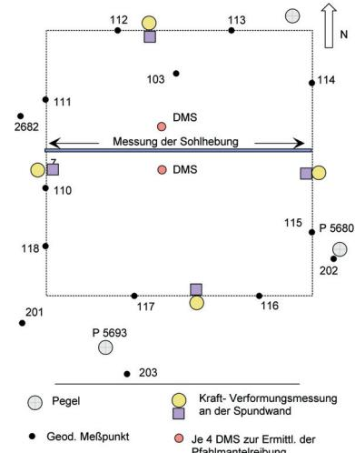
Sohlhebung Vorfeldstation in Abhängigkeit vom Wasserstand in der Baugrube
