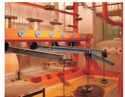
Versuchsstand für die Frost-Tau-Wechsel Experimental setup for the freezing and thawing changes
