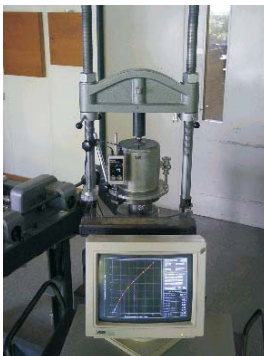
CBR-Versuchsaufbau (Labor) CBR test apparatus (laboratory)
