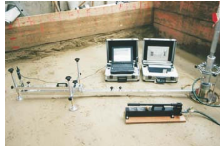
Plattendruckversuch (Versuchsgrube) Plate bearing test (test pit)
