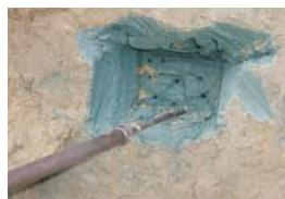
Eindrückversuche mit der Proctoradel an der Dichtwandfläche: n + adhesion
