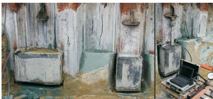
Großscherversuche im Spundwandal (links) und am Spundwandberg (mitte) nach Versuchsdurchführung sowie Versuchseinrichtung am Spundwandberg (rechter Bildteil)
