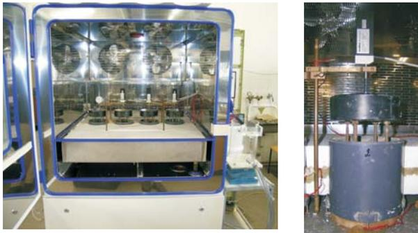
Blick in den Zwei-Kammer-Klimaschrank mit Detailansicht Bodenprobe.
