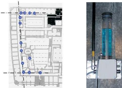
Lage der Messpunkte und Referenzstation der Schlauchwaage im Rathaus, Messgenauigkeit 1/10 mm
