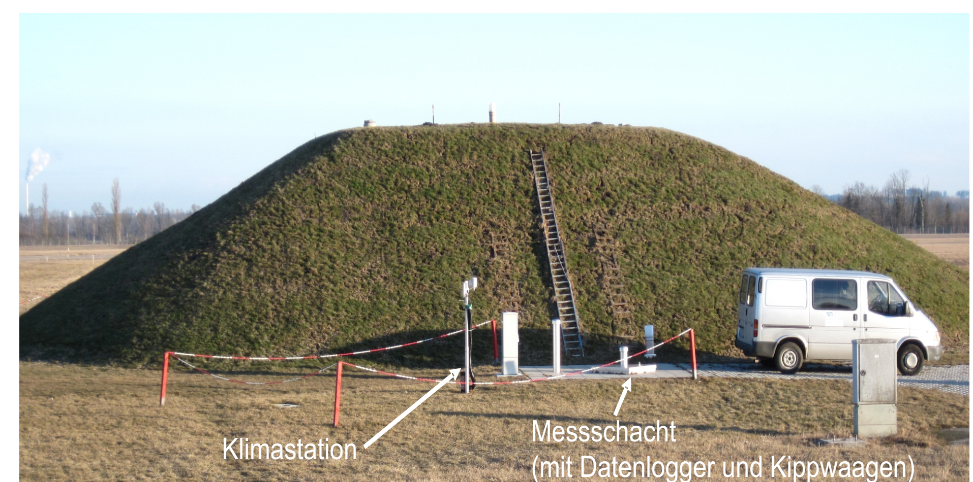
Versuchsschüttung aus einem Ton mit org. Beimengungen earth fill built of clay with organic content
