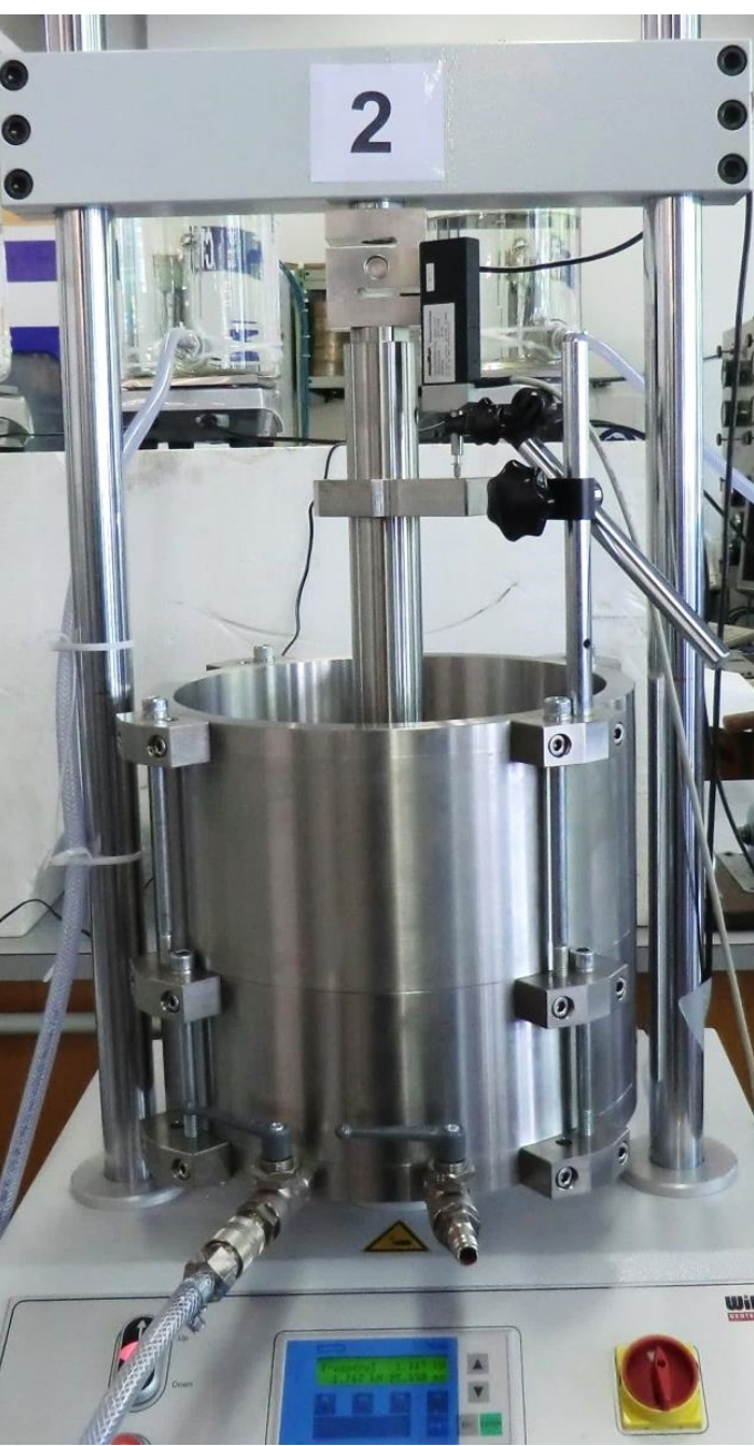
Eindimensionaler Kompressionsversuch - Versuchsgerät und schematischer Versuchsaufbau One dimensional oedometer test - cylindrical oedometer and schematic experimental setup
