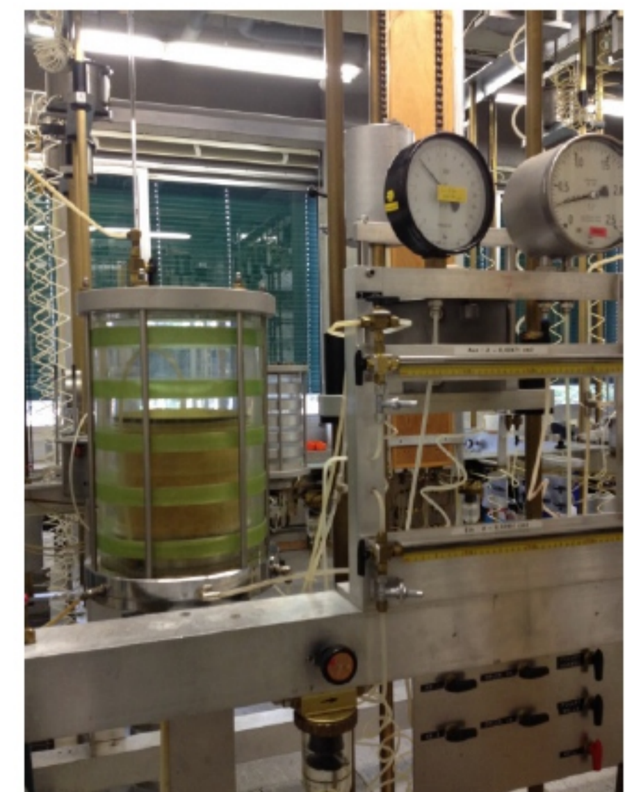
Versuchsstand zur Bestimmung des Durchlässigkeitsbeiwerts nach DIN 18130 experimental stand for determination of the coefficient of permeability according to DIN 18130
