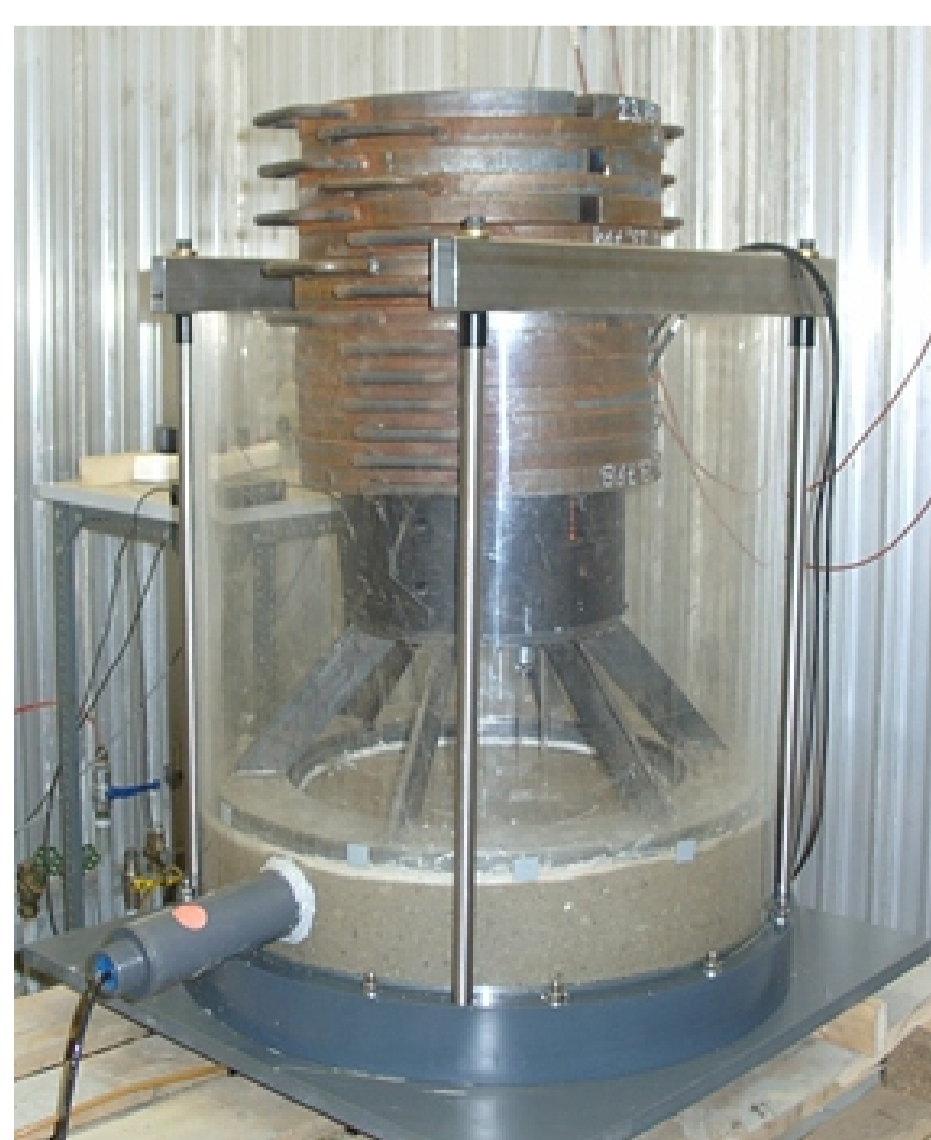
Versuchsstand zur Untersuchung der Witterungsbeständigkeit nach BayFORREST-Forschungsvorhaben F157 (2003) experimental stand for the investigation of the weather resistance according to BayFORREST-Forschungsvorhaben F157 (2003)
