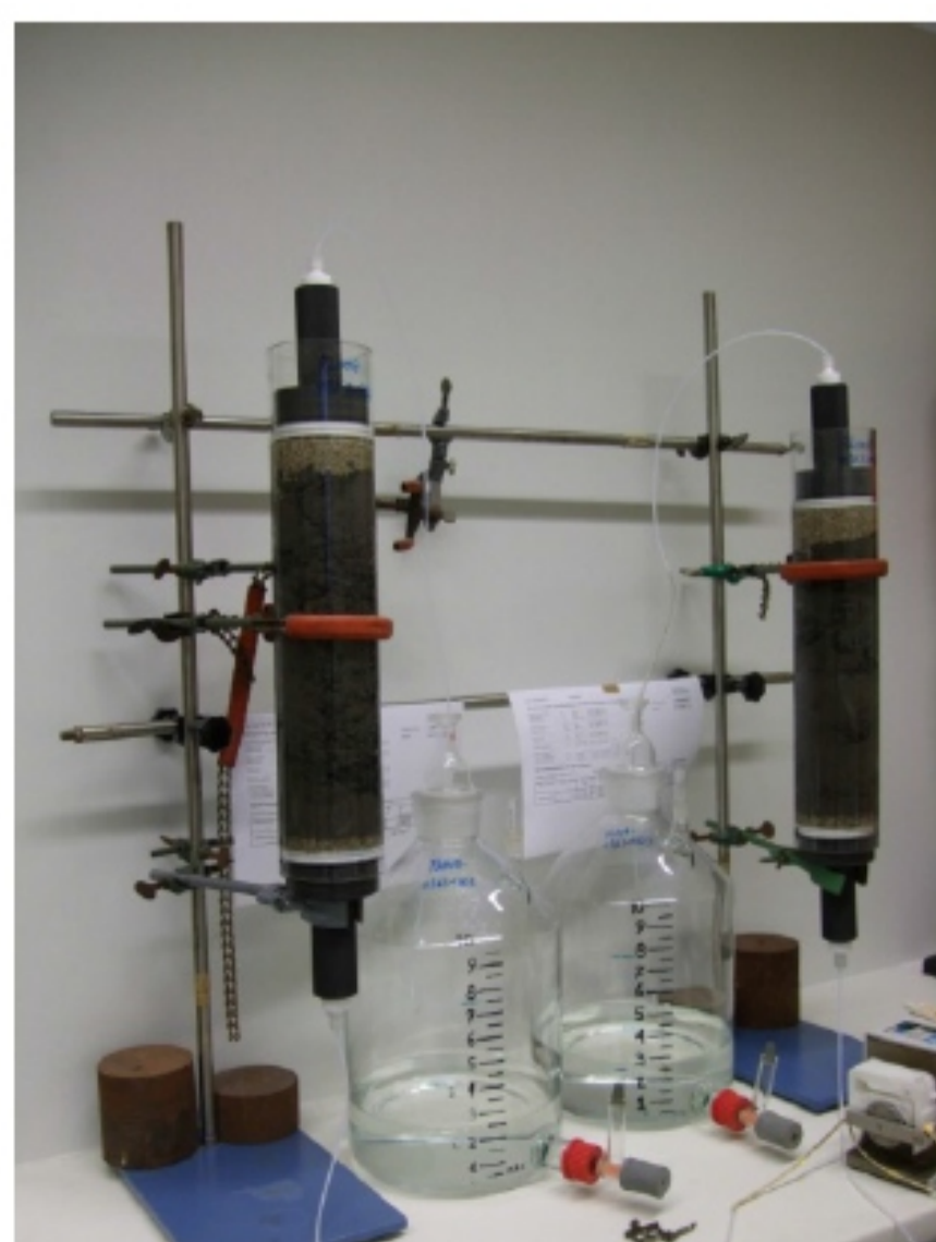
Versuchsstand des Perkolationsverfahrens nach DIN 19528 experimental stand for the percolation process according to DIN 19528
