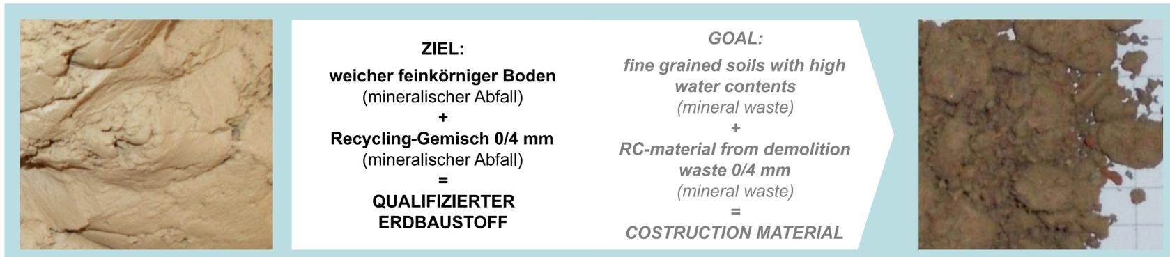
**Faktor Boden.** Die Bodenverbesserung mit RC-Material ist keine mechanische Bodenverbesserung im herkömmlichen Sinne. Durch Krümelbildung und den Feuchtigkeitsaustausch zwischen Boden und Recyclingmaterial wird die Verarbeitbarkeit eines Bodens erweitert. Aus diesem Grund ist die Wirkung bei Böden niedriger Plastizität stärker ausgeprägt, als bei Böden hoher Plastizität.
