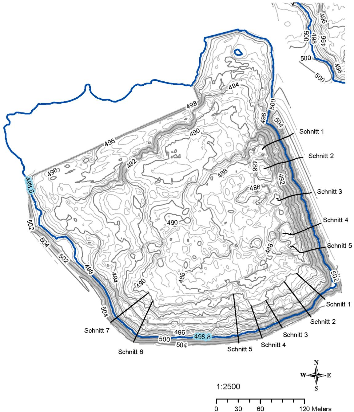
Abbildung A. 8.1: Topographie des Seegrund mit Höhenlinien (0,5 m) mit Darstellung ausgewerteter Schnitte, Fa. Ebenhöh, Gerharding, See 1
