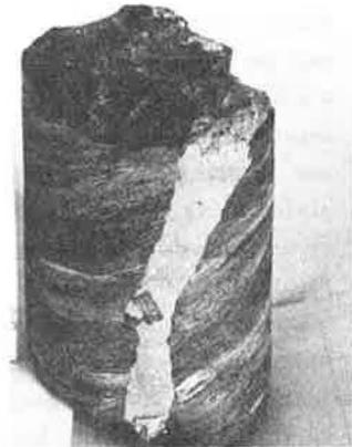
Bild 3 Kernstück aus einer Kontrollbohrung nach erfolgreicher Untergrundinjektion am Loma de Dilar, Spanien
