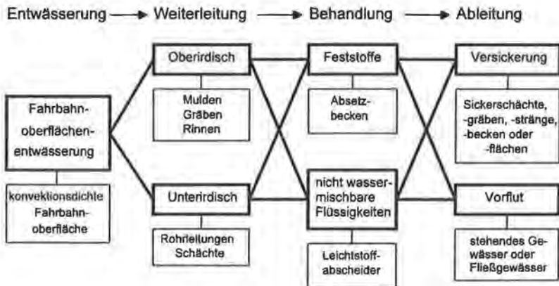
Abb. 5-2: Schematischer Überblick zu Entwässerungseinrichtungen an Straßen
