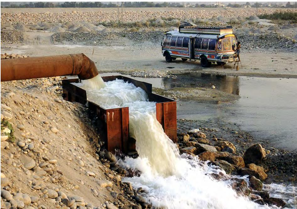
*Bild 26: Wassermengenmessung, unterdimensioniertes Meßwehr*
