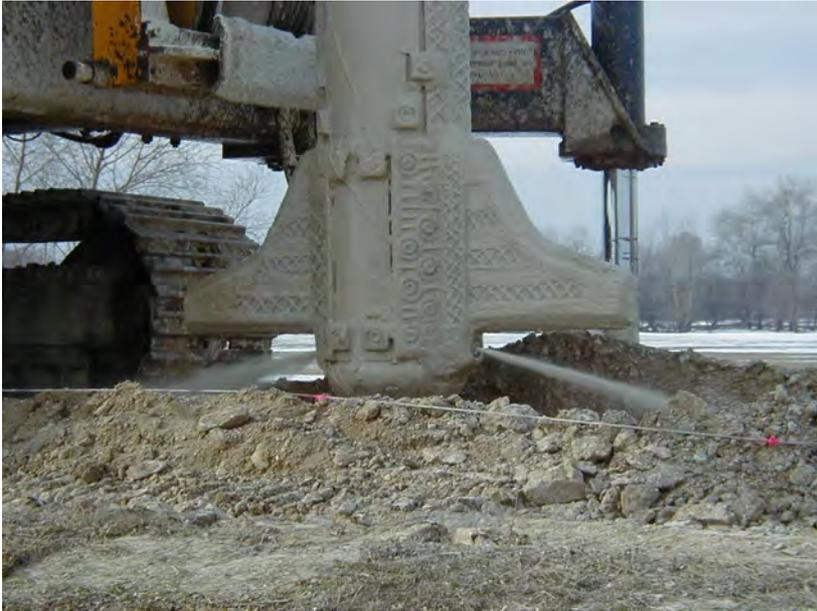
*Bild 30: Flügelrüttler mit Suspensionsdüsen*
