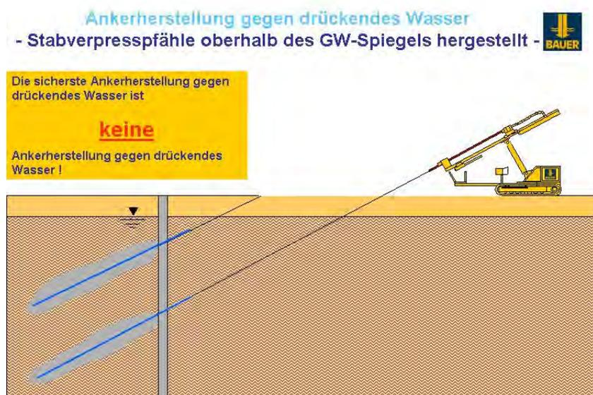
Bild 2: Stabverpresspfähle oberhalb des GW-Spiegels hergestellt.
