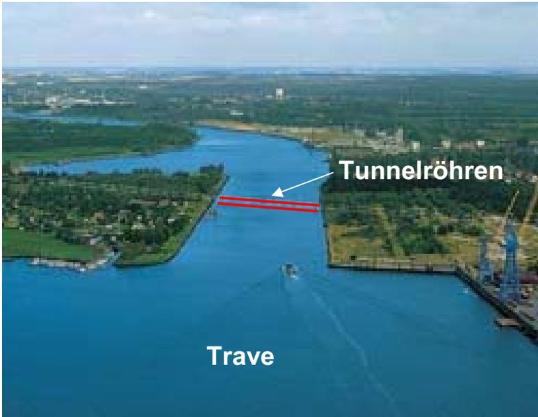
Bild 14: Unterquerung der Trave durch 2 Röhren
