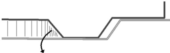
*Bild 14: Boden zwischen den Nocken wird komprimiert und kann zur Tiefe verdrängt werden*
