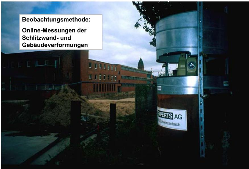
*Bild 4: Totalstation zur Online-Messung der Schlitzwand- und Gebäudeverformungen*
