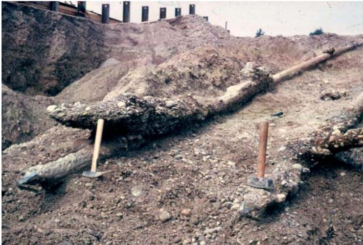
*Bild 11: In injizierbarem Boden hergestellter Erdanker*
