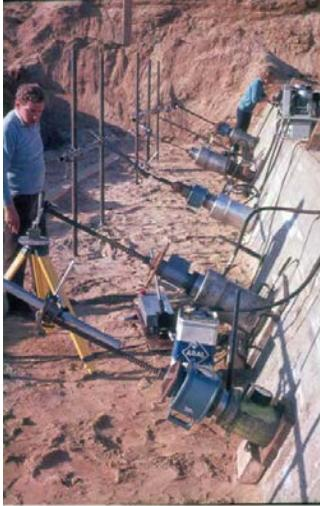
Bild 12: Anker-Versuchsstand München-Obermenzing
