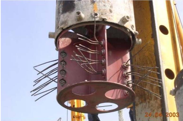
Abbildung 7: Spezial-Reinigungsanfänger mit Bohrkrone (Selbstbau Bilfinger Berger AG)
