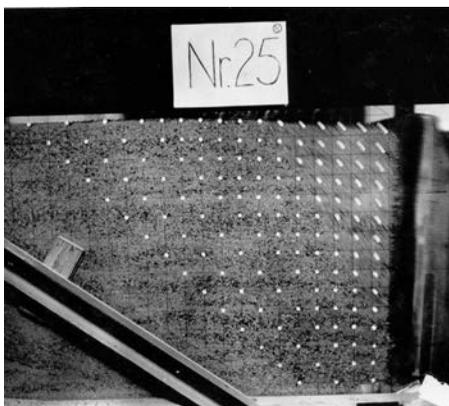
Bild 8: Erddruckversuch mit Bewegungsvektoren
