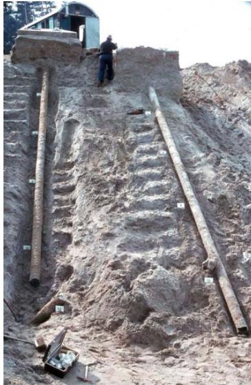
*Bild 10: In nicht injizierbarem Boden hergestellter Erdanker*
