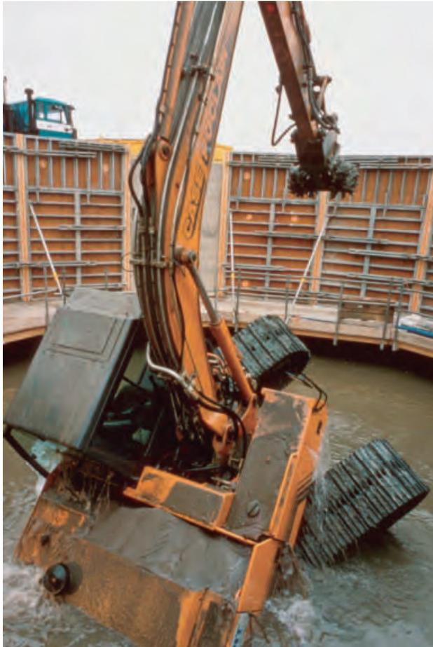
Abb. 3: Bergung des Tunnelbaggers nach Havarie Leidingen Tunnel Rotterdam (1998)
