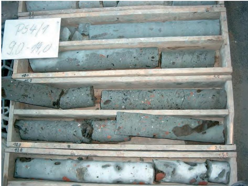
Bild 9: Bohrkern 1 aus Probesäule 4
