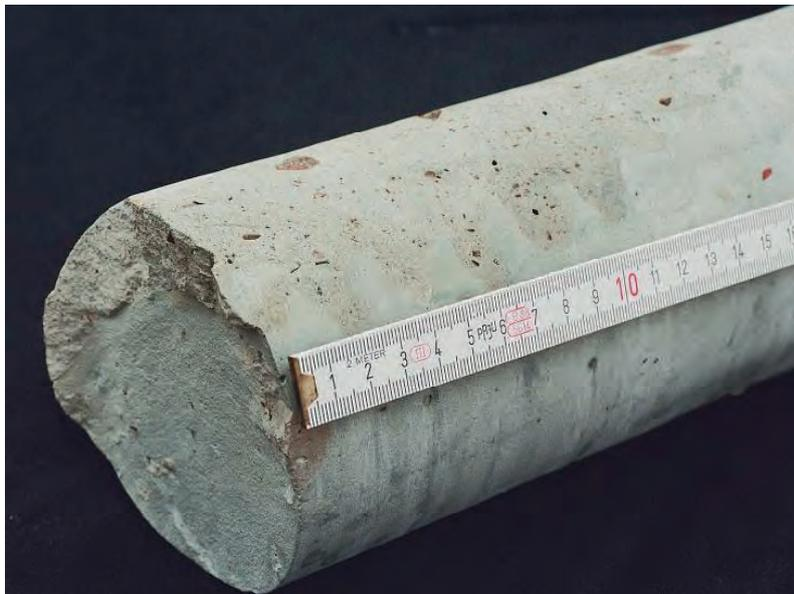
Bild 10: Bohrkern mit Nachschnittprofil
