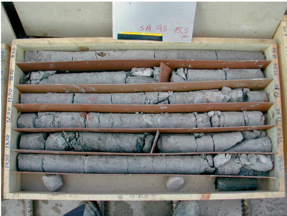
Abbildung 6: Ergebnis einer Kernbohrung in einem Düsenstrahlkörper
