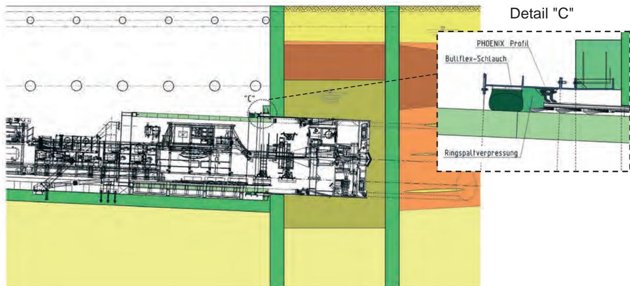
Abb. 8: Langer Dichtwandkasten
