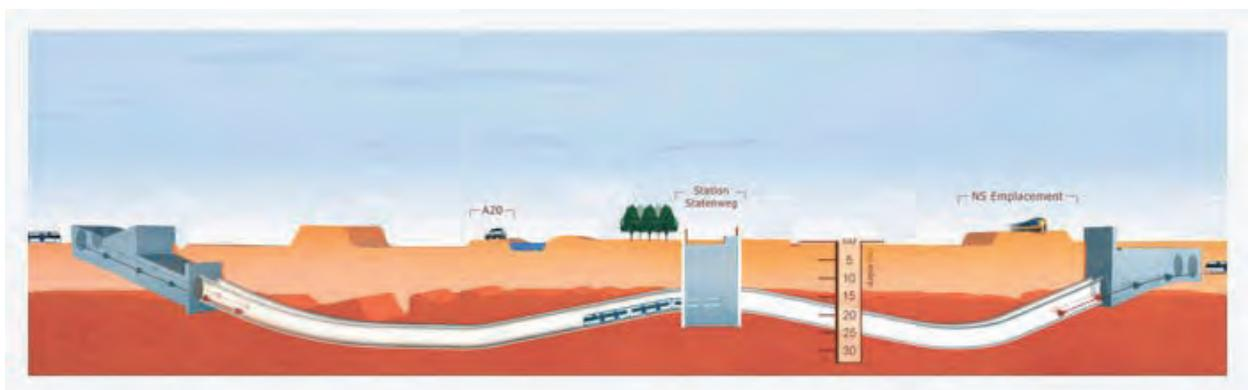
Bild 2: Schnitt durch Bohrtunneltrasse und Bodenaufbau
