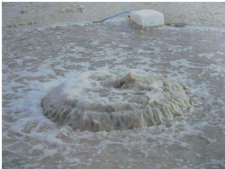
*Bild 3: Hydraulischer Sohlaufbruch*
