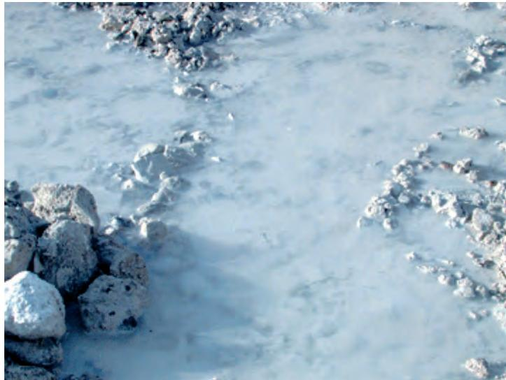
*Bild 1: Kalkausfällungen im Grundwasser*
