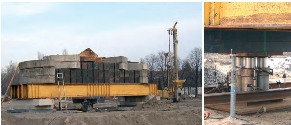
*Bild 8: Probelastung an Säulengruppen – Belastungseinrichtung und Pressen.*
