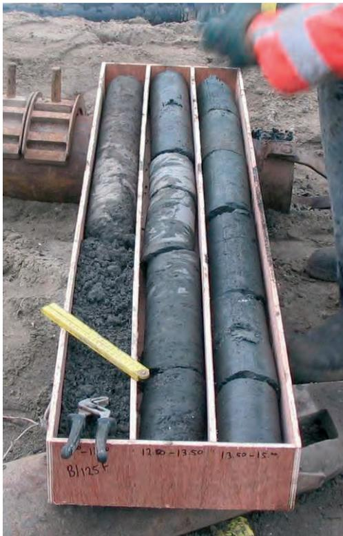
*Bild 20: Kernkiste mit Kalkzement-Kernen*
