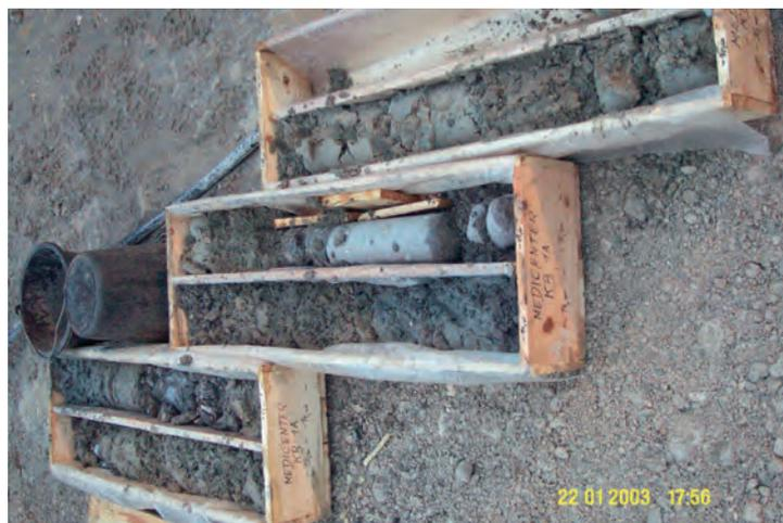
*Bild 5: Kernbohrung durch die Düsenstrahlsohle*
