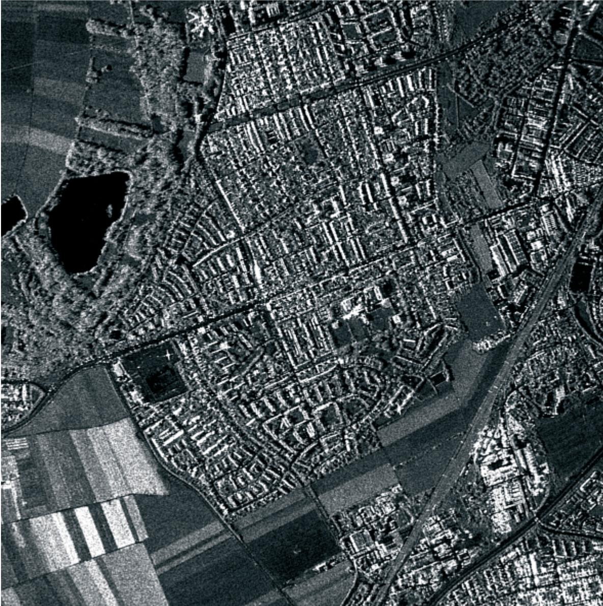
*Bild 9: SAR-Bild vom Flugzeug aus über Ludwigshafen aufgenommen mit ca. 2 m Auflösung. Diese Qualität wird mit TerraSAR-X aus dem Weltraum erreichbar sein.*
