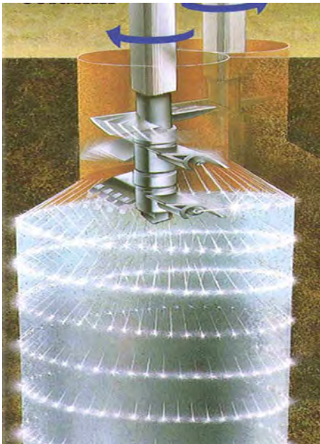
Bild 14a: Doppelpaddel mit Doppeldüse zur Vergrößerung des Durchmessers, Prinzipdarstellung
