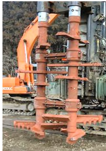
Bild 8b: Detail Paddel mit gegenseitig rotierenden Messern und Flügeln (CDM Association, Japan)
