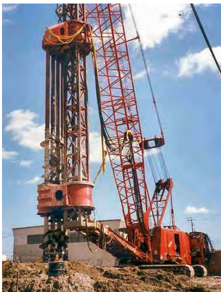
Bild 11a: Vierfachpaddel Geo-Con USA Ø 4 x 1,0m
