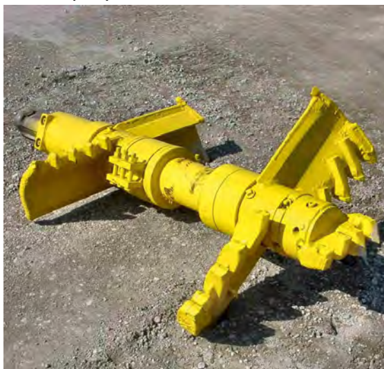
Bild 4c: Detail Mischwerkzeug mit Zahnbesatz, Spitze und Bindemittelauslass
