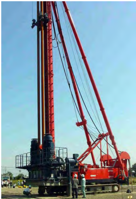
Bild 4a: Mäklergerät mit Doppelpaddel für größere Tiefen (DJM Association Japan)
