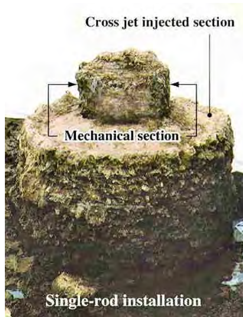
Bild 14c: Freigelegte Säulen und Größenvergleich der erzielten Durchmesser mit und ohne Düsenstrahlunterstützung
