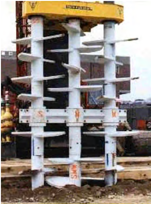
Bild 10a: Dreifachpaddel SWM Seiko Ø 3 x 1,5m
