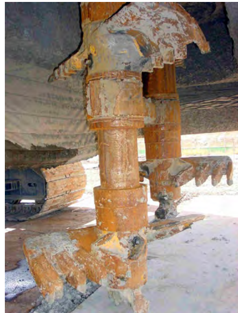
Bild 4b: Detail Doppelpaddel mit gegen einander rotierenden Paddeln
