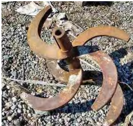
Bild 3e: Mischwerkzeug für torfige Böden
