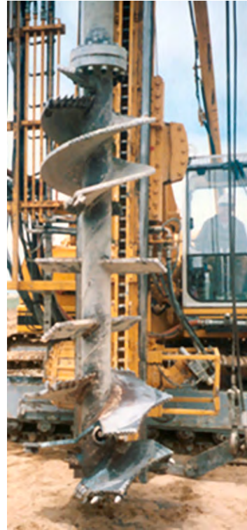
Bild 6b: Einfachpaddel Ø 1,2m
