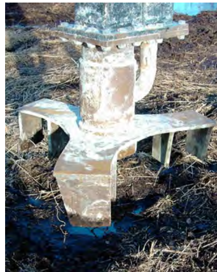
Bild 5c: Mischwerkzeug für die vertikale Durchmischung
