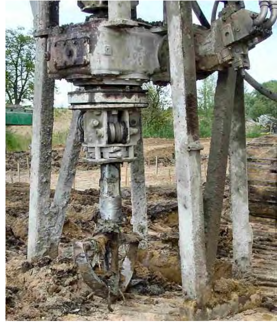
Bild 3b: Detail Mäkler und Antrieb
