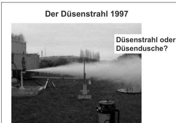
Neben der Tiefenlage der Sohle war noch einiges am Verfahren selbst zu optimieren. Der Düsenstrahl ist um so effektiver, je besser der Strahl gebündelt werden kann. Anfangs sah das eher wie ein Wasserzerstäuber aus.
