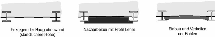
**Bild 4:** kraftschlüssiger Einbau von Holzbohlen für einen Bohrträgerverbau
