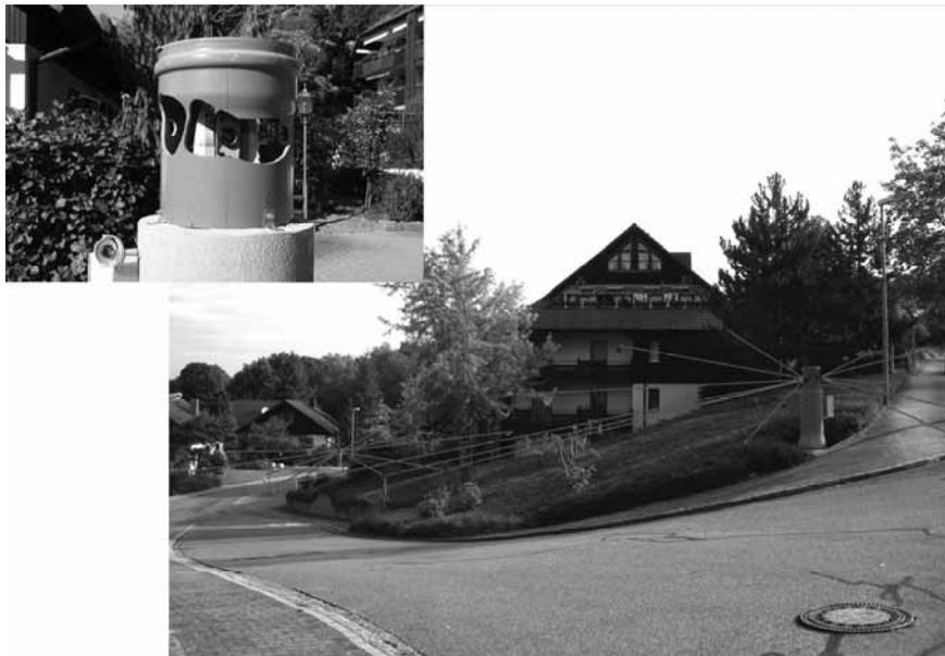
Abbildung 9: Das Bild oben zeigt einen mit einem PVC-Rohr geschützten Tachymeter auf einem festen Pfeiler. Das untere Bild zeigt zwei Tachymeter mit den Blickrichtungen auf die zugehörigen Prismen.
