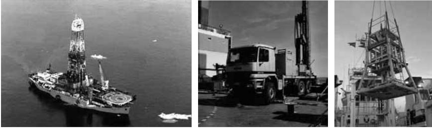
Bild 10: von links: Bohrschiff (© Fugro), Bohrgerät auf Hubinsel (© Keller Grundbau), Drucksonde (© Fugro)
