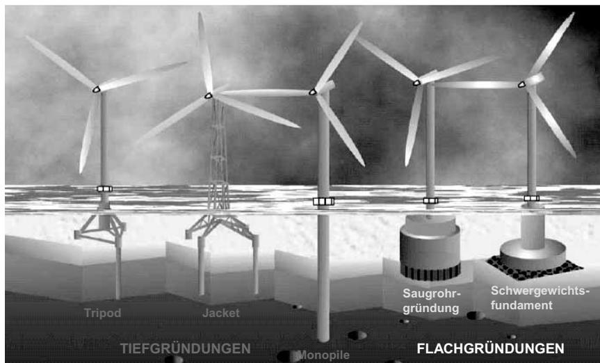
Bild 7: Mögliche Gründungsarten für Offshore-Windenergieanlagen (Wiemann et al.)
