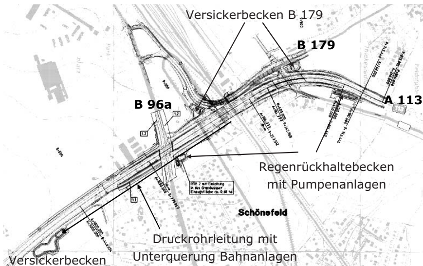
Bild 3: Geplante Entwässerung A 113, B 179 und B 96a
