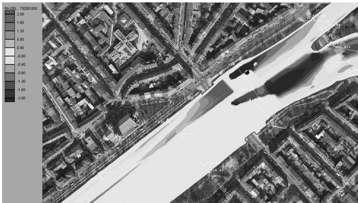
Abbildung 12 Ergebnis der morphologischen Berechnungen (IB IFH)
