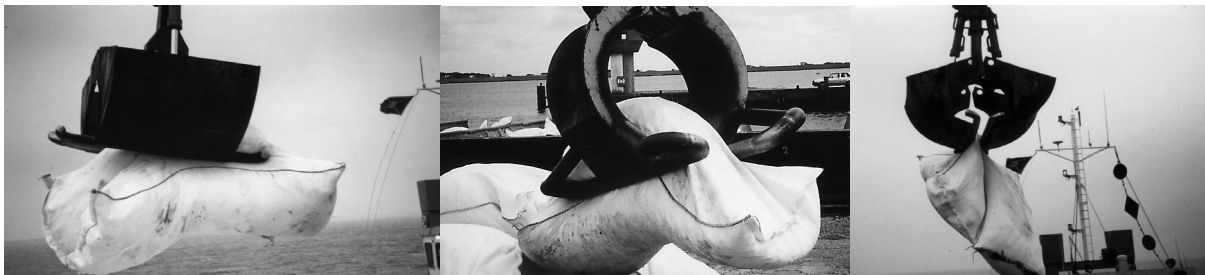
Bild 6: Robustheit der Sandcontainer aus dehnfähigem vernadeltem Vliesstoff ( V = 1 m 3 )
