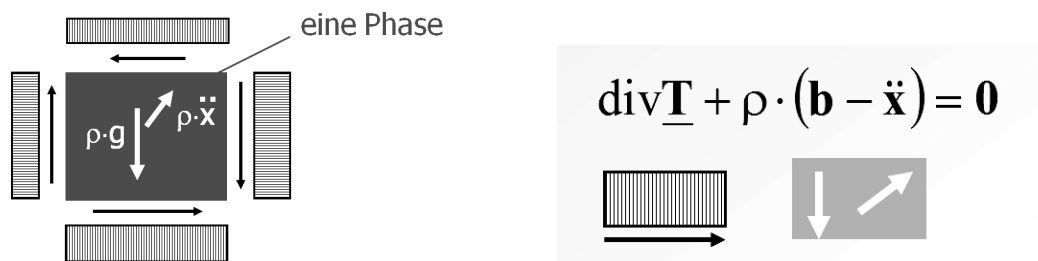
Bild 2: Differenzielles Element und daran wirkende Kräfte bei einer Phase (links), zugehörige Gleichung zur Erhaltung der Bewegungsgröße (rechts)
