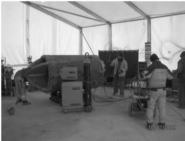
*Bild 5: Schweißwerkstatt zur Aufarbeitung und Reparatur von Bohrwerkzeugen*
