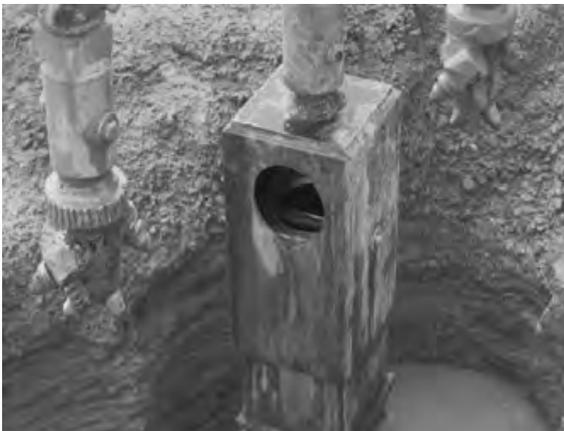
Bild 3: Probeentnahmegesät „System Keller Grundbau“
