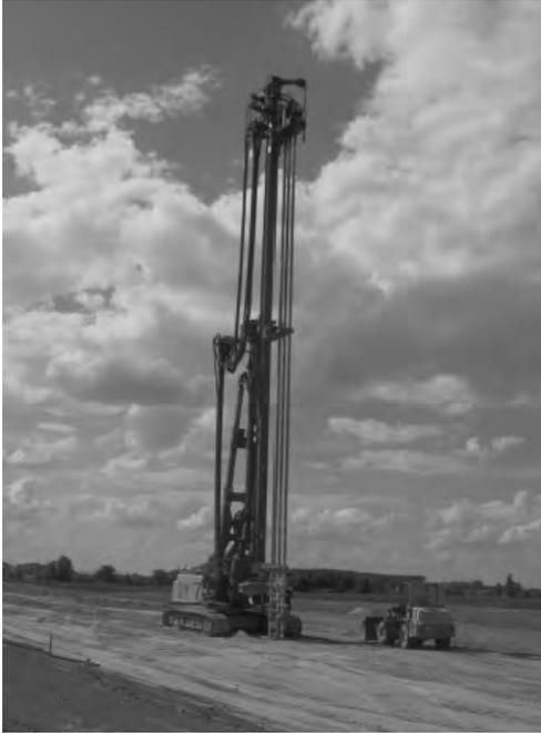
Bild 1: Einbaugerät Liebherr LRB 155 mit 3-fach Paddel
