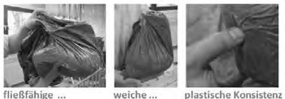
Bild 7: Das Erstarrenverhalten eines Betons kann im „Knetbeutel“ beobachtet werden [5]
