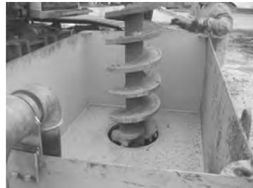
Bild 10: Bestimmung des Stützflüssigkeitsverbrauchs im Feldversuch
