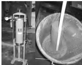
Bild 6: Das Wasserrückhaltevermögen eines Betons unter Druck wird mit der BAUER Filterpresse untersucht
