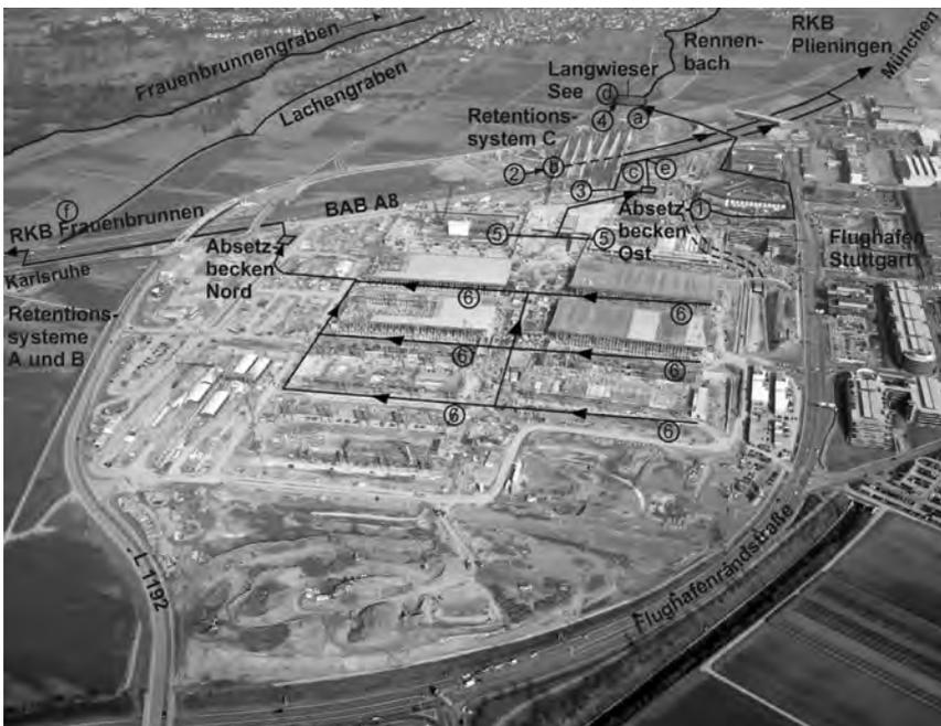
Abb. 9: Bauzeitliche Entwässerung der Neuen Landesmesse Stuttgart (Luftbild vom 20.09.06, ProNM)
