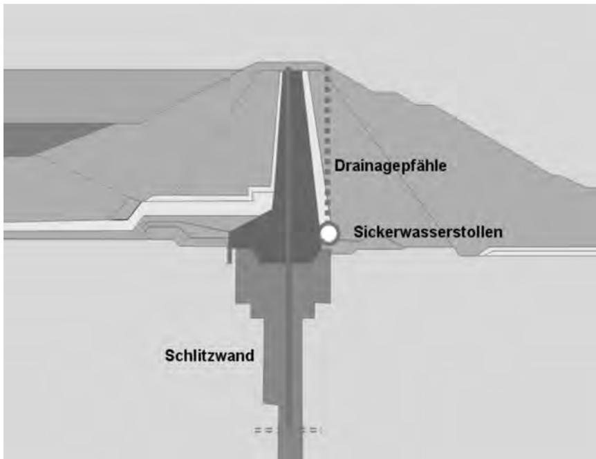
Bild 1: Schematischer Querschnitt durch den Sylvensteindamm mit zusätzlicher Schlitzwand und neuem Sickerwassermeßsystem
