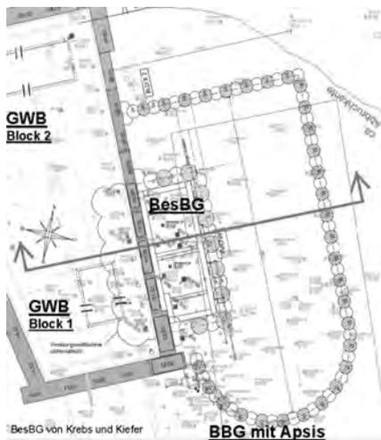
Bild 15: Grundriss GWB (Gleiswechselbauwerk), BBG (Bergebaugrube), BesBG (Besichtigungsbaugrube) innerhalb der Grundfläche der BBG
