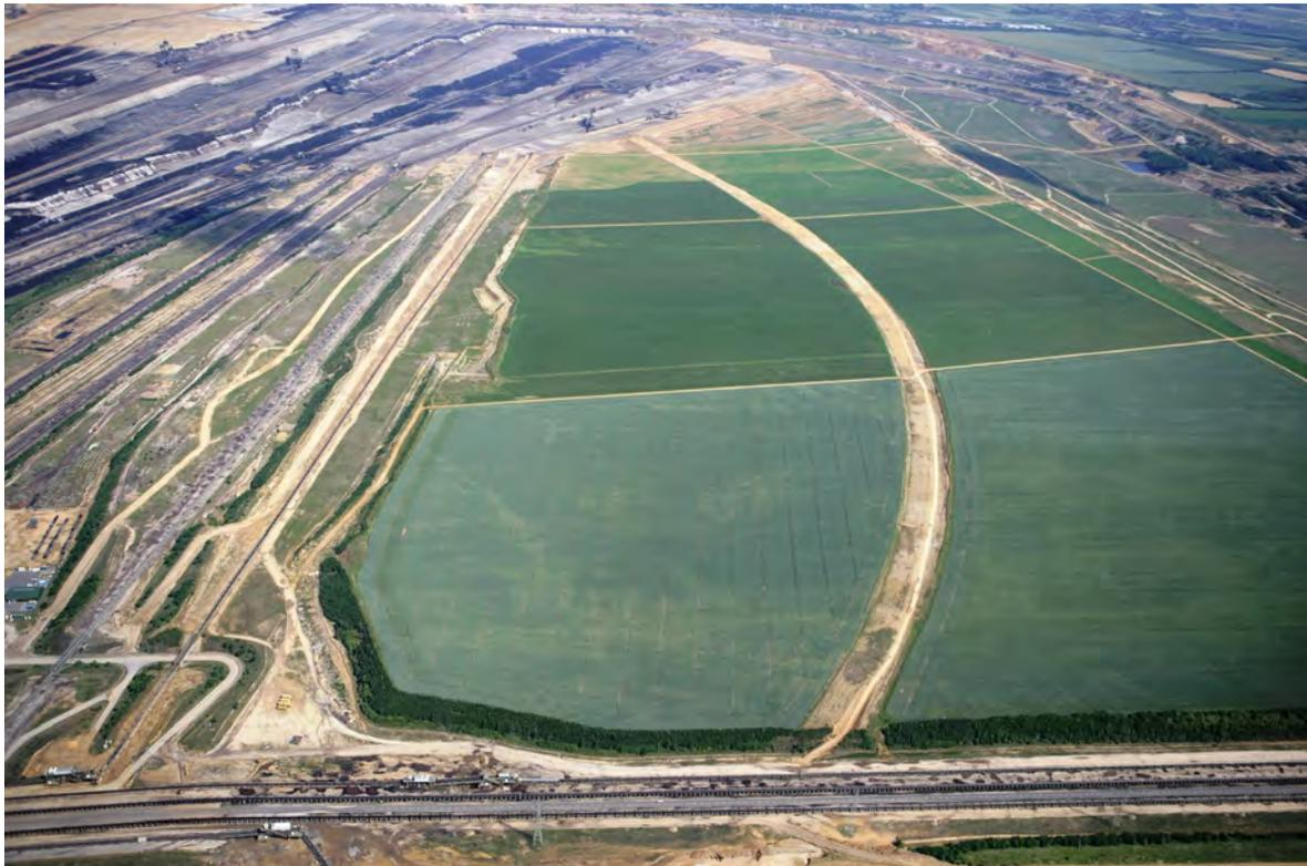
*Abbildung 2: Rekultivierte Fläche sowie freigehaltene Trasse der A 44 im Tagebau Garzweiler*
