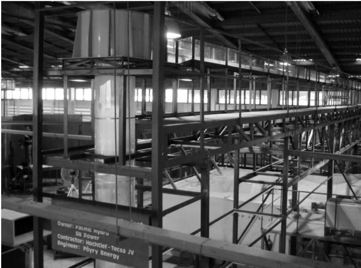
Bild 4: Physikalisches Modell des Wasserschlosses im Maßstab 1:25
