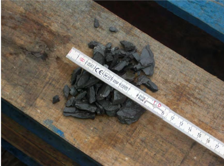
Bild 11: Sand-/ Schluffstein aufgefangen während des Bohrvorgangs
