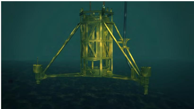
Bild 9: Bohrschablone am Meeresgrund mit teilweise ausgefahrenen Füßen
