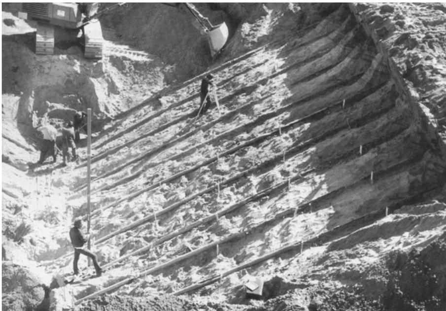
Bild 1: Grundlagenversuche zur Erlangung einer allgemeinen bauaufsichtlichen Zulassung in einer Sandgrube; hier: Beurteilung der freigelegten Anker
