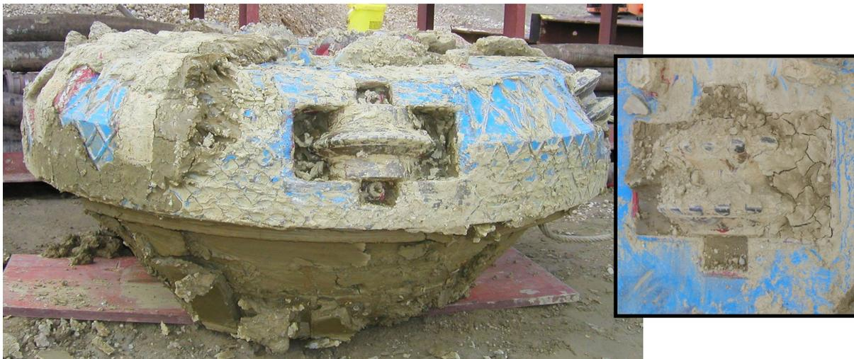
Abb. 5: Beispiel eines mit Ton verklebten Schneidrads
