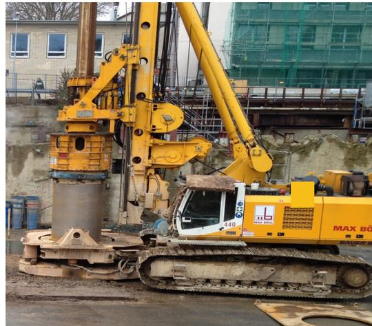
**Bild 1:** Drehbohrgerät im Einsatz
