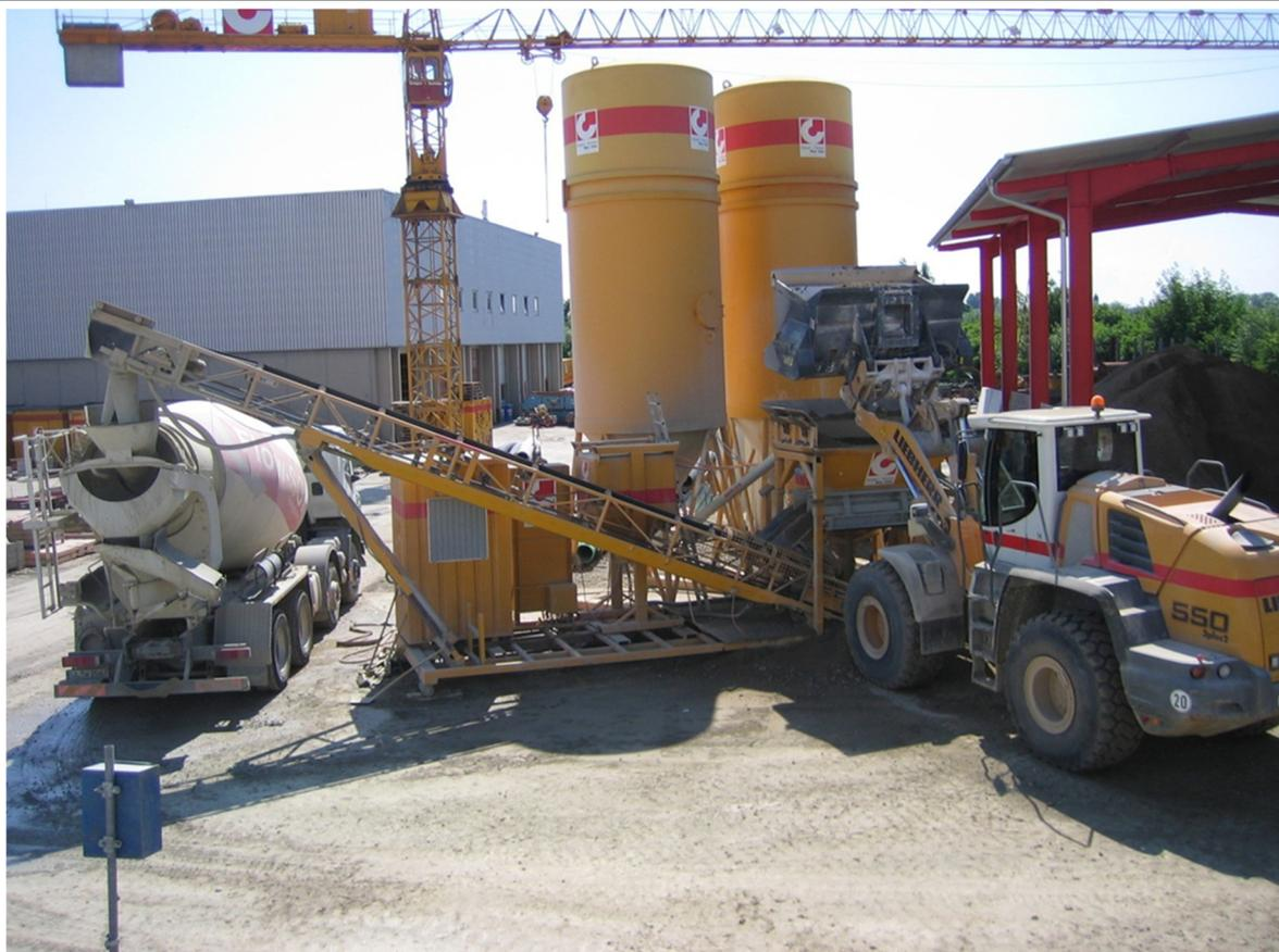
Bild 10: Stationäre Mischanlage der G+S / Soiltech, Ulm mit überdachter Lagerfläche für den Ausgangsboden, Vorratssilos für Zement und Bentonit, Förderband mit Waagent und Fahrmischer.
