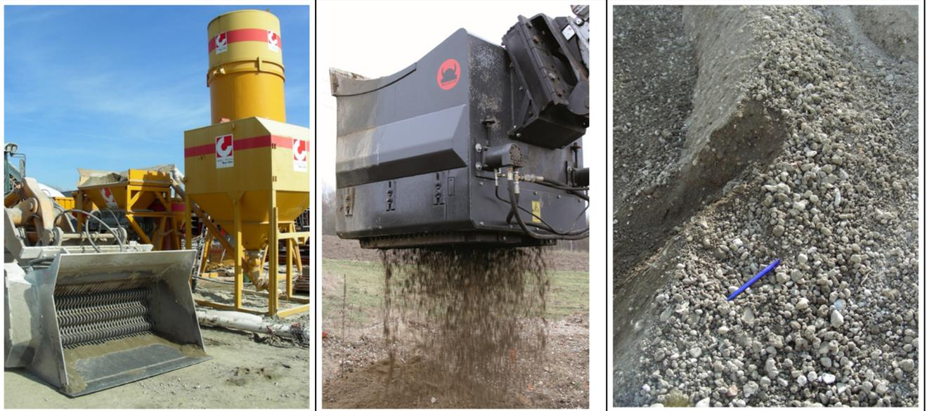
Bild 9: Aufbereitung des Ausgangsbodens zur Herstellung des ZFSV Typ c). Links und Mitte: Schaufelseparatoren zur Zerkleinerung / Zerkrümelung des Ausgangsbodens ggf. mit Einsatz von Weißfeinkalk (Quelle: G+S / Soiltech, Ulm). Rechts: Haufwerk des Endprodukts (Hier: TA).
