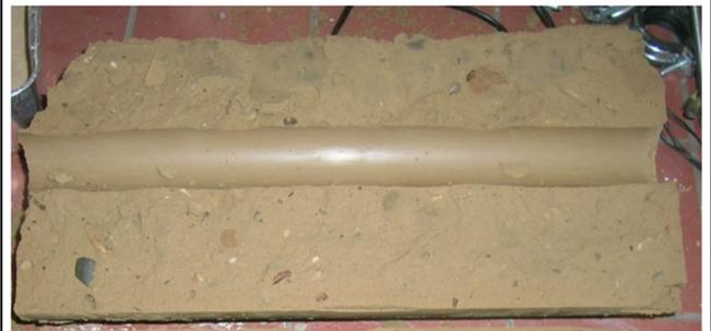
Bild 11: Geteilte Proben nach Entnahme des Versuchsrohrs D = 40 mm. Links: ZFSV Typ a). Rechts: ZFSV Typ c).
