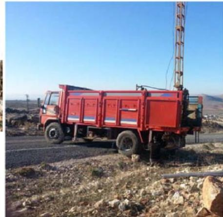
**Bild 12/13:** Baugrunduntersuchung mit Kernbohrungen nach EN ISO 22475-1
