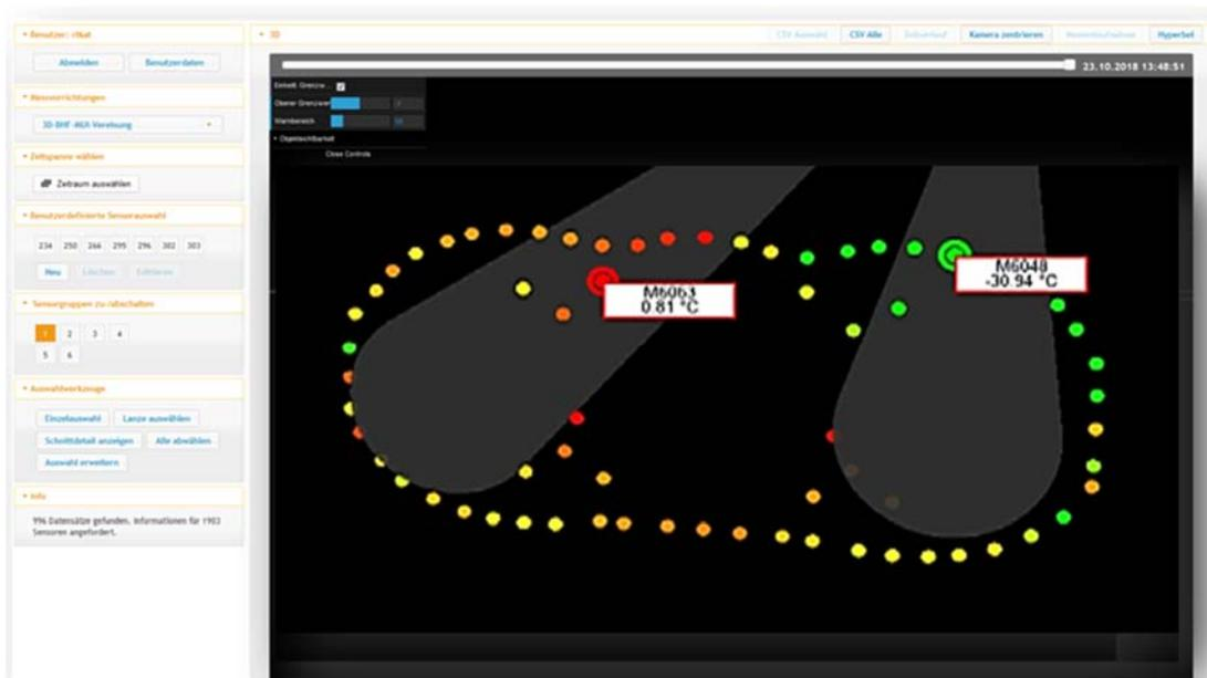
Bild 15-2: Webbasierte 3D-Oberfläche des Temperaturanalysestems (TAS)
