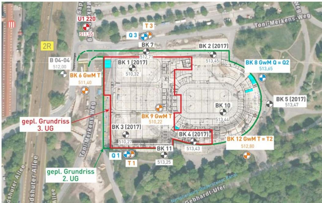
Abbildung 11: Grundriss des Neubaus mit Lage der Erkundungspunkte
