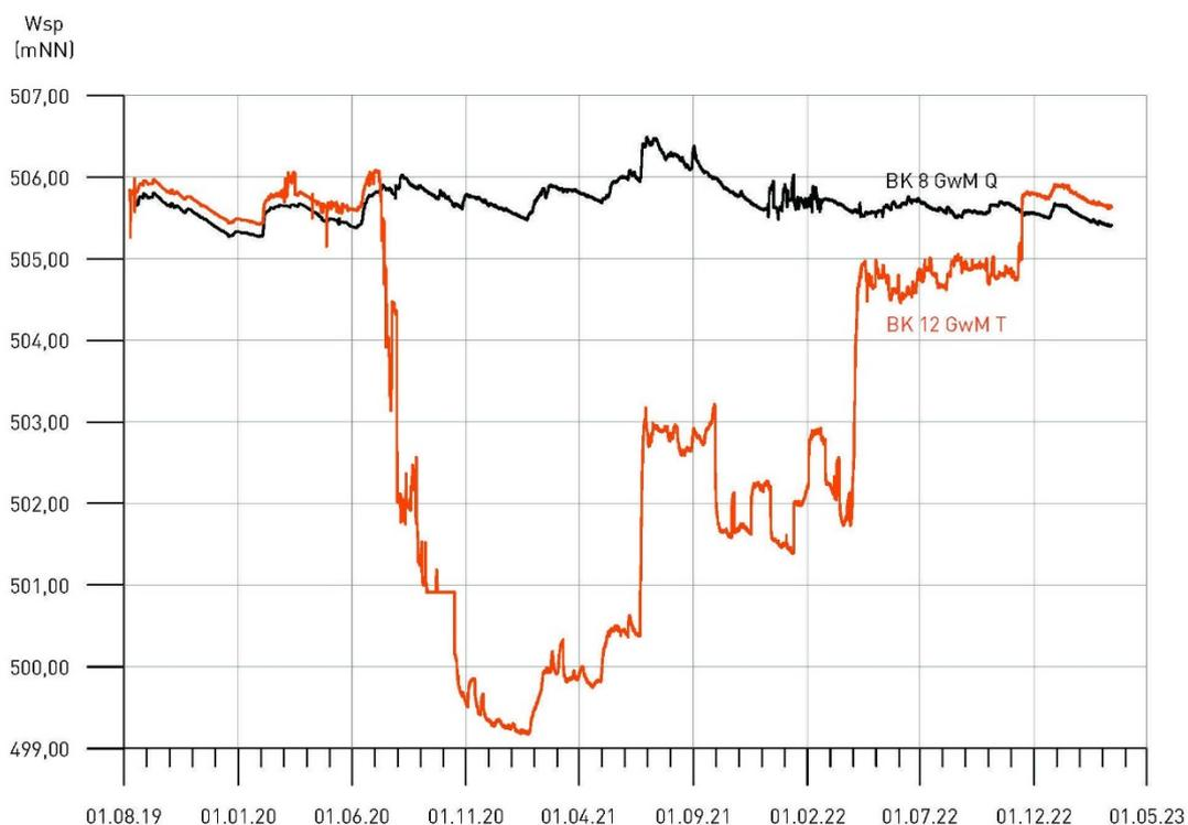
Abbildung 15: Ganglinien in einer quartären (BK 8 GwM Q) und einer tertiären (BK 12 GwM T) Grundwassermessstelle außerhalb der Baugrubenumschließung während der Wasserhaltung
