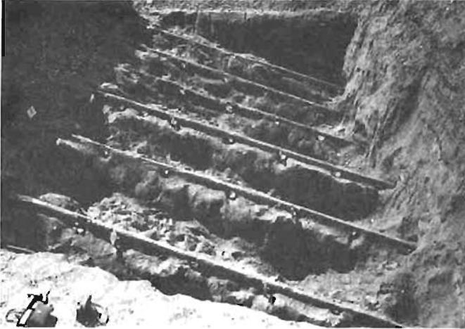
Abb. 5: Freigelegte Verpreßkörper einer Versuchsreihe
