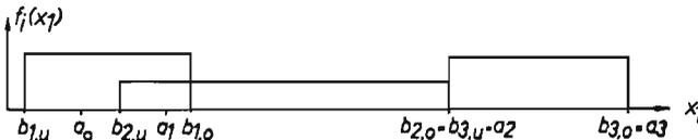
Bild 2: Gleichverteilte a priori Dichten für den Mittelwert  $X_1$  für drei verschiedene Klassen und Klassierungsintervalle  $[a_{i-1}, a_i]$  für den Stichprobenmittelwert.
