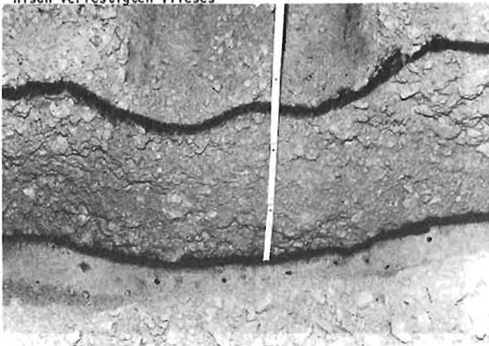
Bild 9: Spurrille im Oberbau (Zwillingsreifen, Oberbau: Oolomit), Ausbildung der Spurrinne auf LÖB bei Verwendung eines mechanisch verfestigten Vlieses
