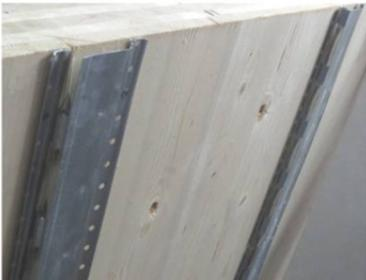
**Bild A.3:** Massivholzschale des Prüfkörpers IWT 2 bzw. TW 2, Montagezustand vor dem Anbringen der Gipskartonbeplankungen
