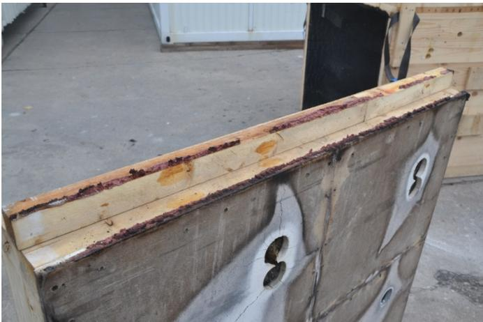
Abbildung 3-16 Versuch V2a: Ansicht des Fugenbereichs nach der Versuchs- und Branddurchführung. Es sind nirgends verfärbte/verkohlte Stellen aufgetreten, der Brandschutzschaum hat die Fuge vollständig ausgefüllt.
