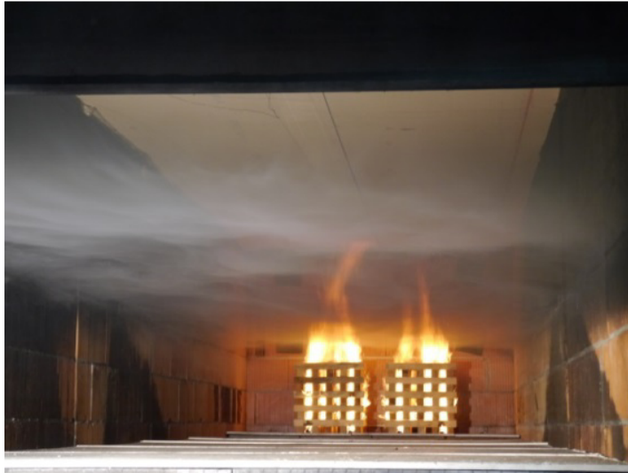
Abb. 4: Großbrandversuch: Prüfung eines vorelementierten Prüfkörpers nach DIN 18234-1
