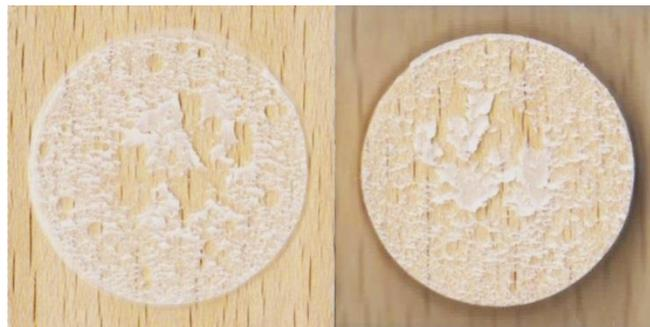
**Abbildung 26:** Typisches Bruchbild der Klebstofffuge
