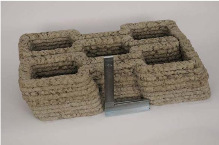
*Abbildung 4: Durch Extrusion von Holzleichtbeton gefertigtes Testobjekt mit Überhang*
