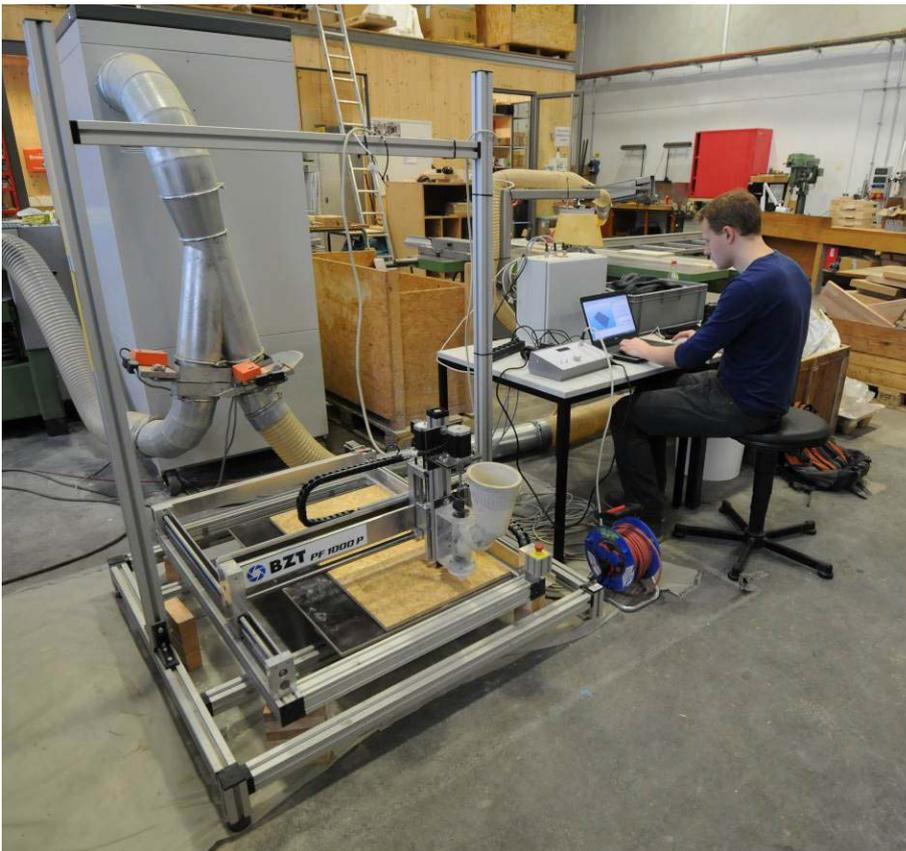
Abbildung 3: Portalsystem mit montiertem Versuchsextruder
