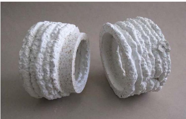
*Abbildung 5: Durch Extrusion additiv gefertigtes und mittels Fräsen partiell subtraktiv nachbearbeitetes Testobjekt aus Holzleichtbeton (Modellbau S. Stanglmayr)*
