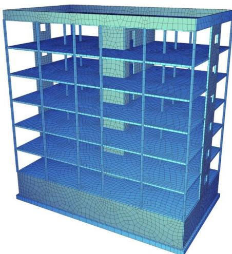
Abbildung 2-1: Dreidimensionales Rechenmodell eines Skelettbaus (Eigene Darstellung)
