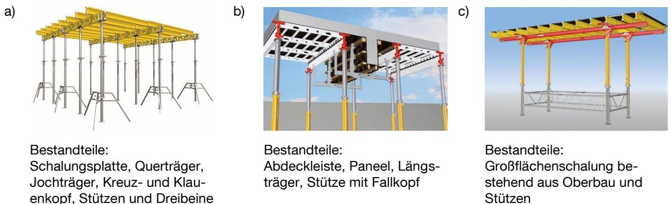
Abbildung 3-6: Übersicht der üblichen Systeme bei Deckenschalungen (Peri, o.J.), a) Trägerschalung, b) Paneel-Träger-Schalung, c) Deckentische
