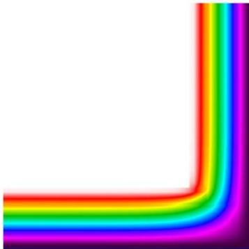
Abbildung 2-28: Geometriebedingte Wärmebrücke (Eigene Darstellung)
