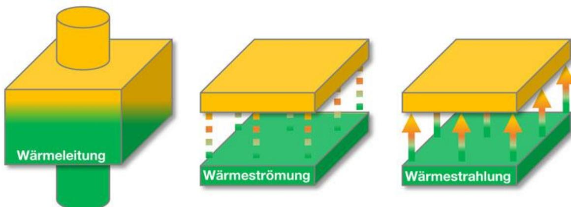
Abbildung 2-26: Arten des Wärmetransports (Schopbach, 2014, S. 143)
