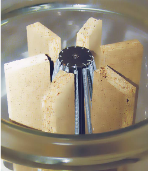
Abbildung 17-7: Exsikkator-Verfahren DIN EN ISO 12460-4 (Schwab et al. 2004)
