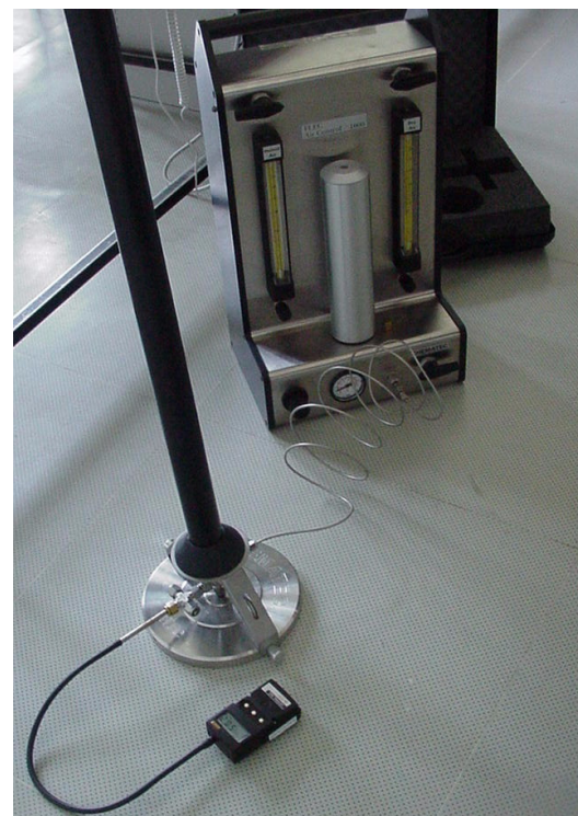
Abbildung 17-9: Beschreibung einer Emissionsprüfzelle (DIN EN ISO 16000-10:2006) und Beispiel einer Emissionsprüfzelle (Landesamt für Umwelt Rheinlandpfalz o.J.)
