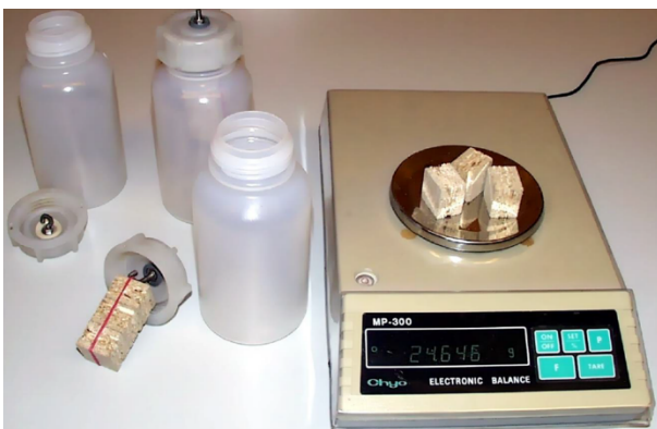
Abbildung 17-6: Flaschen-Methode gemäß DIN EN 717-3 (Schwab et al. 2004)
