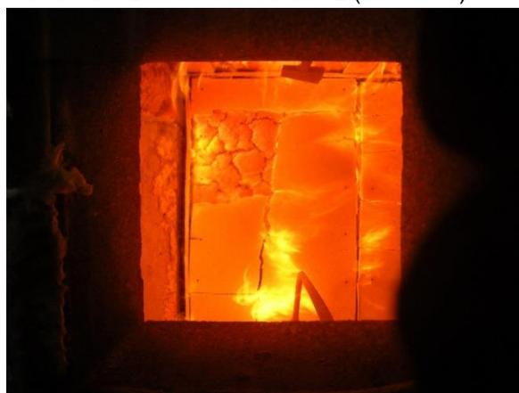
Abbildung 232: Abfallen von Teilen der Gipsplatte in der Wand Gefach 1 (28. Minute)
