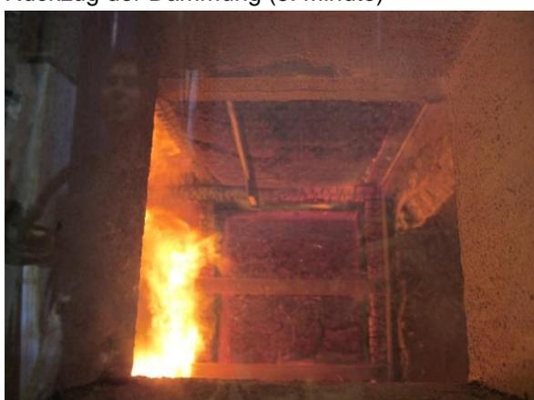
Abbildung 98: Entzünden der Spanplatte, da Rückzug der Dämmung vom Rahmen an der Wand im Gefach 2 (8. Minute)
