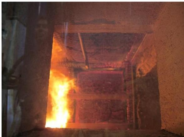
Abbildung 188: Entzünden der Spanplatte, da Rückzug der Dämmung vom Rahmen an der Wand im Gefach 2 (8. Minute)
