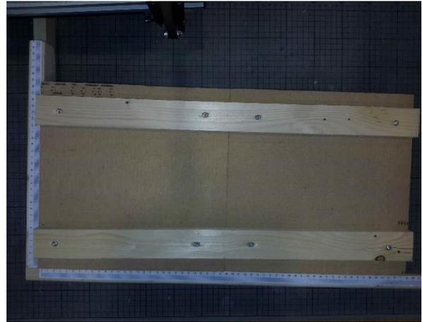
Abbildung 14: Prinzip der Befestigung der Prüfkörper 8, 9, 12, 13
