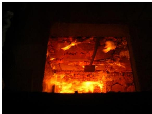
Abbildung 254: Lattung an der Decke (Gefach 1) nahezu abgebrannt (22. Minute)
