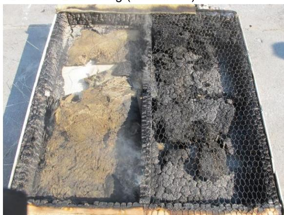
Abbildung 193: Versuchskörper Decke nach Versuchsende
