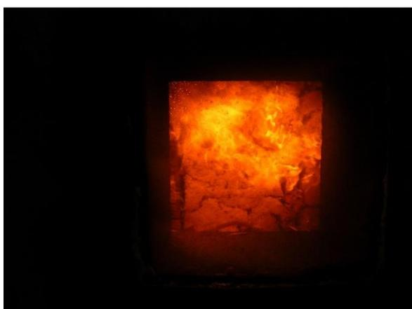
Abbildung 257: Brennen der Zellulose an der Wand (Gefach 1) (60. Minute)
