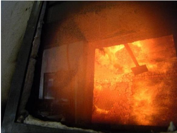
Abbildung 146: Durchzünden hinter Decke G1 (42. Minute)
