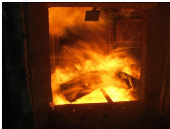
Abbildung 187: Herausfallen der Dämmung aus Gefach1 der Wand (6. Minute)
