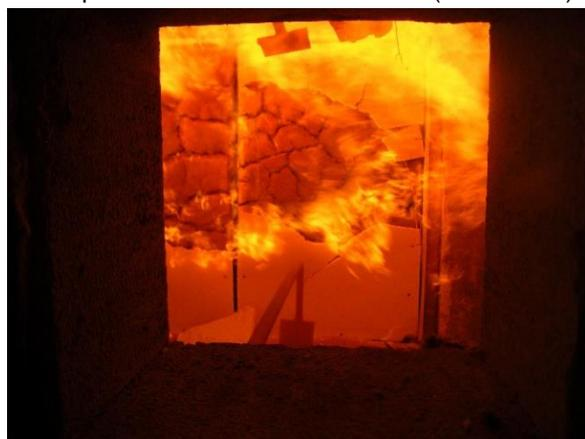
Abbildung 281: Abfallen der Gipsplatte an der Wand im Gefach 2 (32. Minute)
