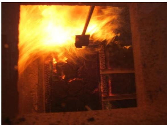
Abbildung 186: Entzündung der Spanplatte im oberen Teil des Gefaches 1 der Wand nach Rückzug der Dämmung (5. Minute)
