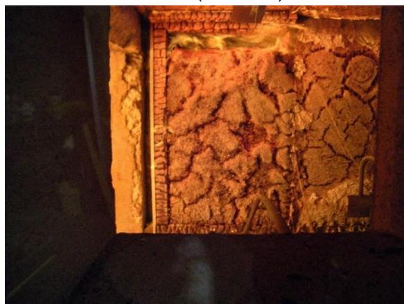
Abbildung 252: Weiteres Zusammensacken der Dämmung und erneutes Brennen der dahinterliegenden Spanplatte in der Wand Gefach 1 (12. Minute)
