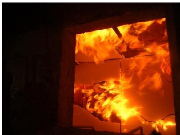
Abbildung 279: Abfallen eines Teiles der Gipskartonplatte an der Wand Gefach 1 (26. Minute)
