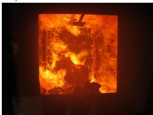
Abbildung 120: Gipsplatte Wand weggefallen, Durchzündung (28. Minute)
