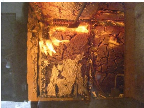
Abbildung 138: Zündung im Spalt Wand G1 (10. Minute)
