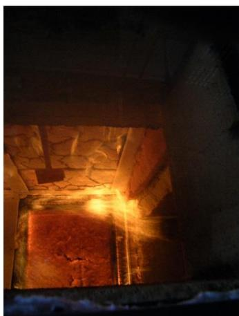
Abbildung 209: Brennen Holzweichfaser und der dahinterliegenden Spanplatte in der Wand Gefach 2 (23. Minute)
