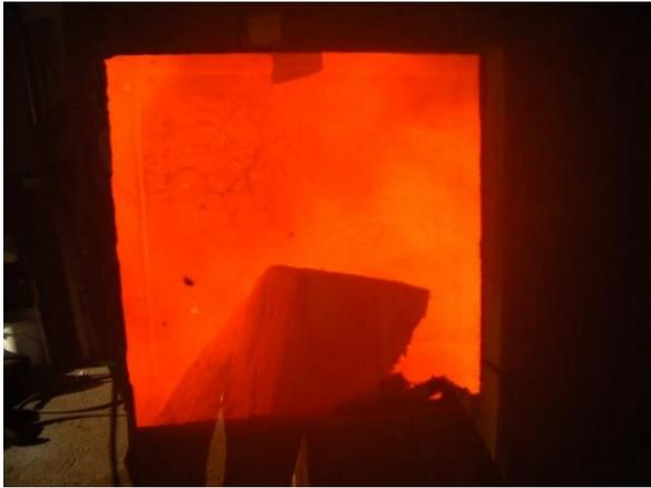
Abbildung 303: Abfallend der GKF-Platten an Decke und Wand und der Holzweichfaser an der Decke (33. Minute)
