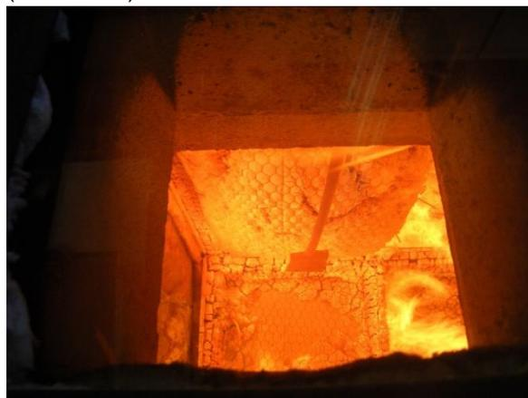
Abbildung 145: Decke G1 baucht sehr stark (41. Minute)
