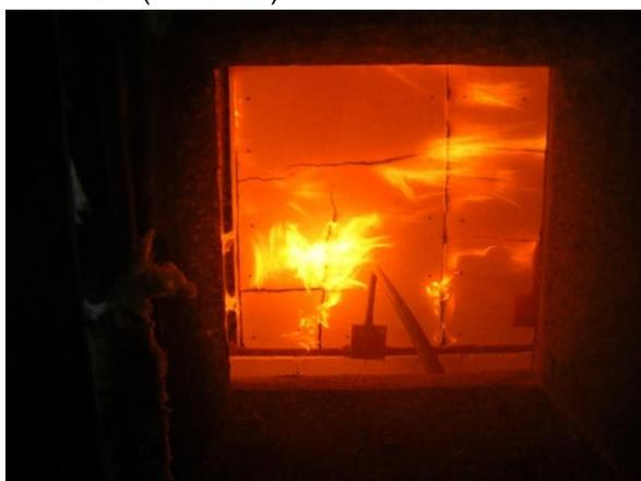
Abbildung 231: Entzündung hinter den Rissen der Gipsplatten an den Wänden (19. Minute)
