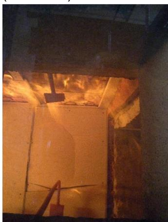
Abbildung 207: Holzwolle hinter Gipsplatte brennt (18. Minute)
