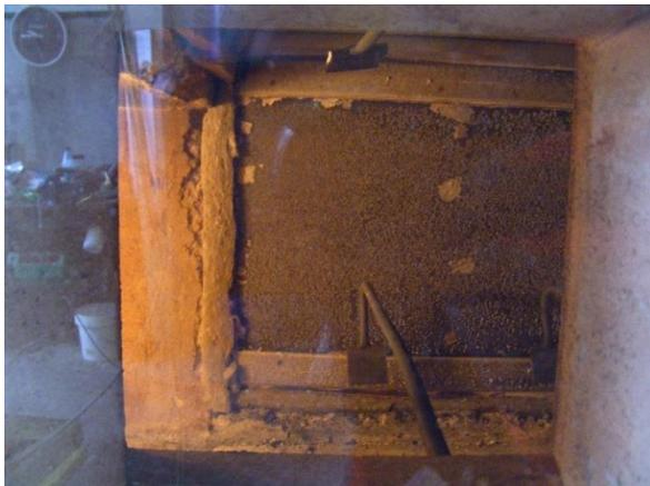
Abbildung 335: Schwarzfärbung der Gipskartonplatten (3. Minute)
