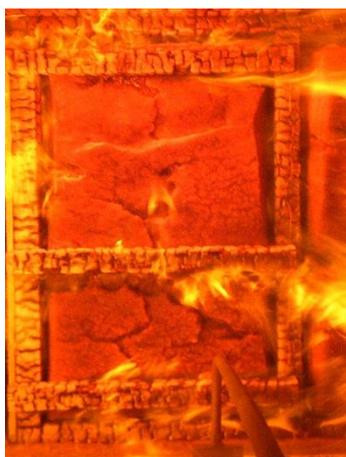
Abbildung 164: Erhöhter Rückzug der Dämmung vom Rahmen Wand G1 (9. Minute)
