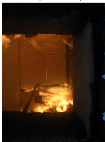
Abbildung 208: Gipsplatte an der Wand Gefach 2 zum Teil abgefallen (20. Minute)
