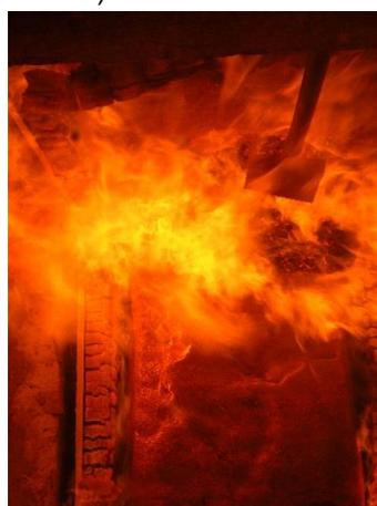
Abbildung 167: Dämmung Decke G1 herausgefallen (23. Minute)
