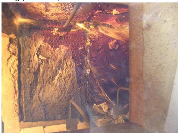
Abbildung 136: deutlicher Spalt zwischen Rähm und Zellulose Wand G1, Risse in HW Wand G2 (5. Minute)
