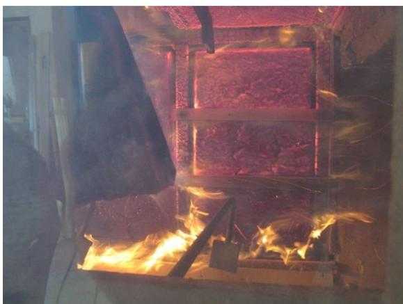
Abbildung 95: Herausfallen der Decke 1 und starkes Schrumpfen der Holzwolledämmung (2. Minute)
