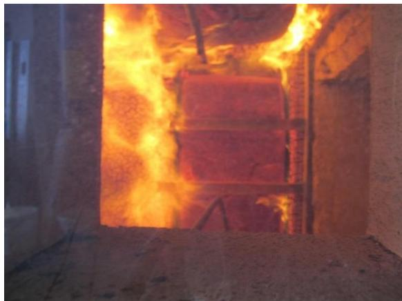
Abbildung 101: starkes Durchhängen der Dämmung im Gefach 2 der Decke und Durchzünden hinter der Dämmung (13. Minute)
