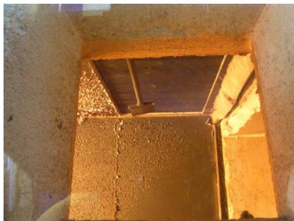
Abbildung 273: Schwarzfärbung der Gipskartonplatten und der Massivholzplatte (4. Minute)
