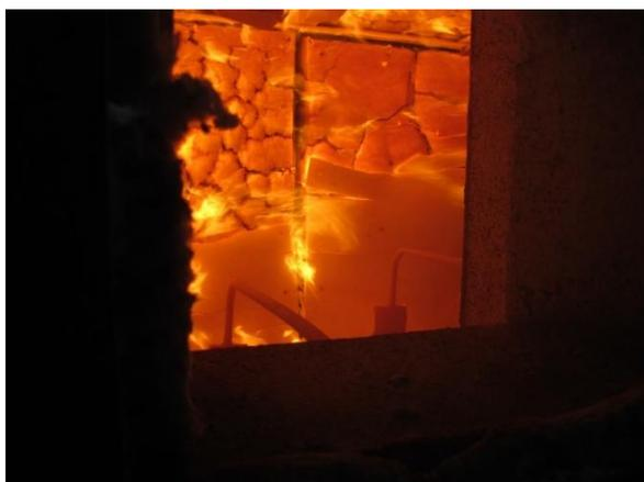
Abbildung 233: Abfallen des oberen Teiles der Gipsplatte an der Wand des Gefachs 2 (35. Minute)
