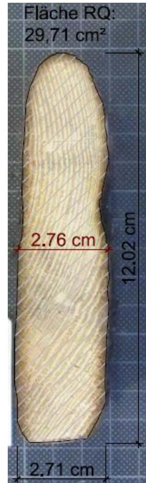
Abbildung 359: Restquerschnitt
