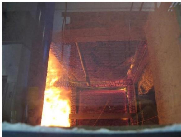
Abbildung 189: Entzündung des Rahmens an der Decke im Gefach 2 (8. Minute)
