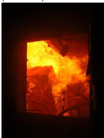
Abbildung 168: Dämmung Wand G1 kippt oben (32. Minute)
