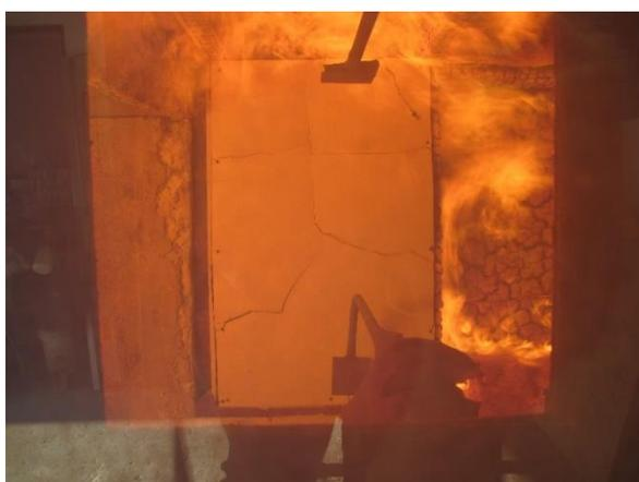
Abbildung 119: Gipsplatte Wand G1 reißt stark (19. Minute)
