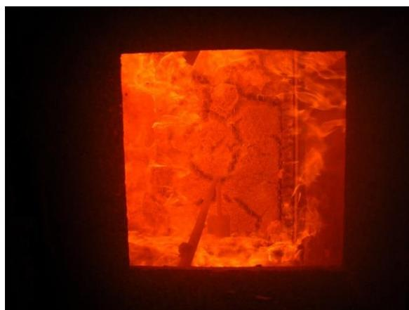
Abbildung 256: Durchzündung, da die Zellulose in der Decke (Gefach 1) herausgefallen ist (33. Minute)
