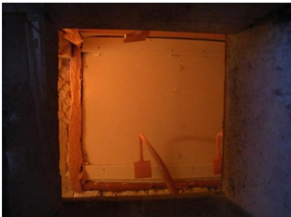
Abbildung 337: langsames Bauchen der Wand oben und Decke (28. Minute)
