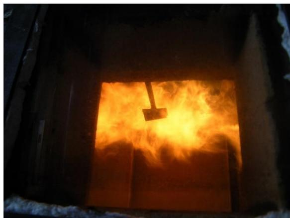
Abbildung 202: Durchzündung der Decke (2. Minute)
