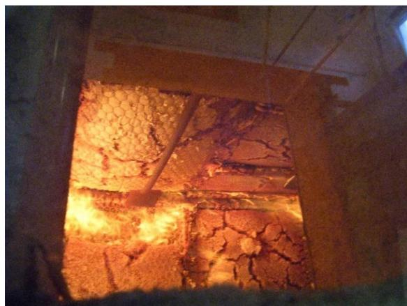
Abbildung 139: 1 cm Spalt zwischen Rähm und Zellulose in Wand G2, Zündung des Rahmens (15. Minute)
