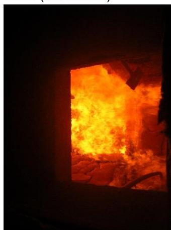
Abbildung 169: Dämmstoff Wand G1 herausgefallen (33. Minute)
