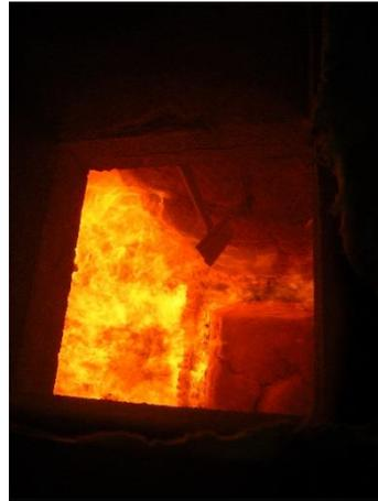
Abbildung 171: Dämmung Wand G2 zieht sich zurück (36. Minute)
