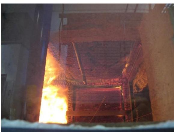
Abbildung 99: Entzündung des Rahmens an der Decke im Gefach 2 (8. Minute)
