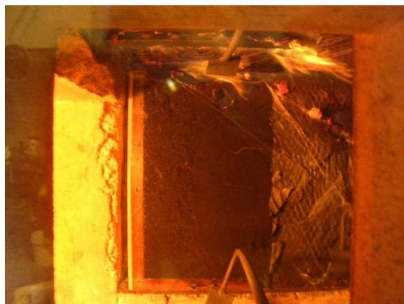
Abbildung 248: Abschmelzen der Dampfbremse und Brennen des Rahmens der Wand (Gefach 1) im Bereich der Fuge durch schlechte Verdichtung der Zellulose beim Einblasen (1. Minute)
