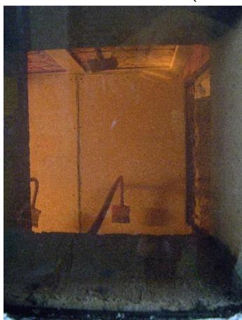
Abbildung 205: Riss in GKB der Wand Gefach 2 (13. Minute)
