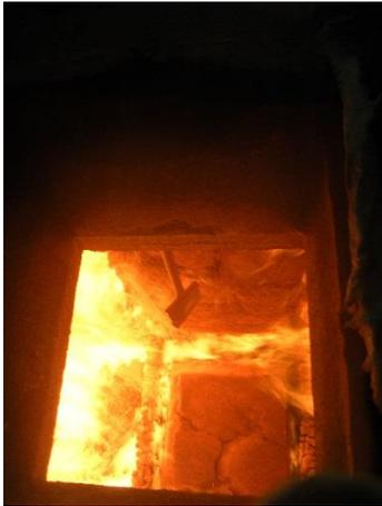
Abbildung 170: Dämmung Decke G2 wölbt sich stark (34. Minute)
