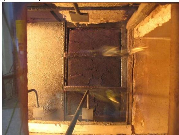
Abbildung 112: Durchzünden der Holzwolle in der Wand im Bereich der Lattung und Rückzug der Holzwolle in Decke und Wand vom Rahmen (5. Minute)
