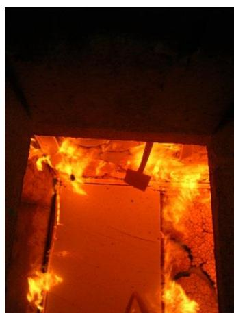
Abbildung 212: Brennen des Rahmen hinter GKP Wand Gefach 1 (44. Minute)
