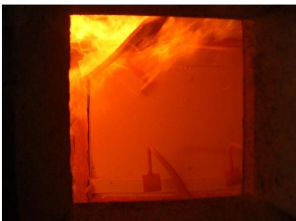
Abbildung 339: Versagen der GKF Decke (38. Minute)
