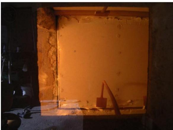
Abbildung 301: Brennen in den Fugen zum Rahmen (17. Minute)
