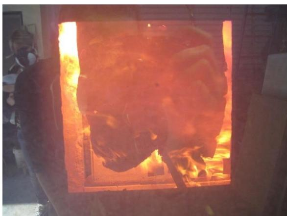
Abbildung 117: Dämmung Decke G1 ganz herausgefallen (13. Minute)
