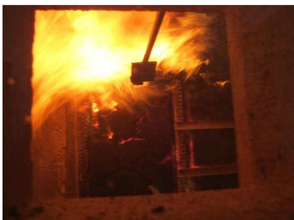
Abbildung 96: Entzündung der Spanplatte im oberen Teil des Gefaches 1 der Wand nach Rückzug der Dämmung (5. Minute)
