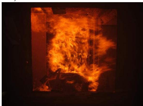
Abbildung 118: Dämmung Wand G2 herausgefallen, Protect-Platte dahinter brennt (14. Minute)
