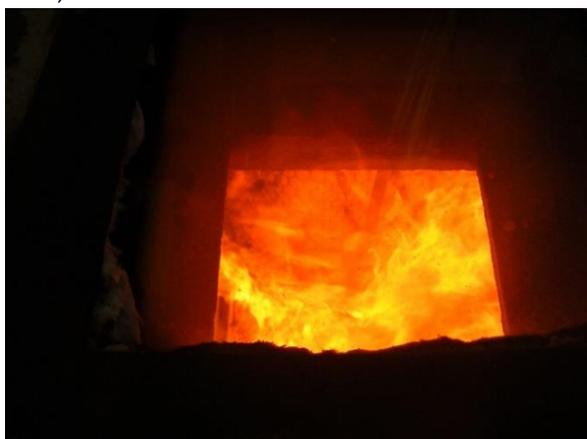
Abbildung 142: Abfallen von Teilen der Dämmung Decke G2, Durchzündung (20. Minute)
