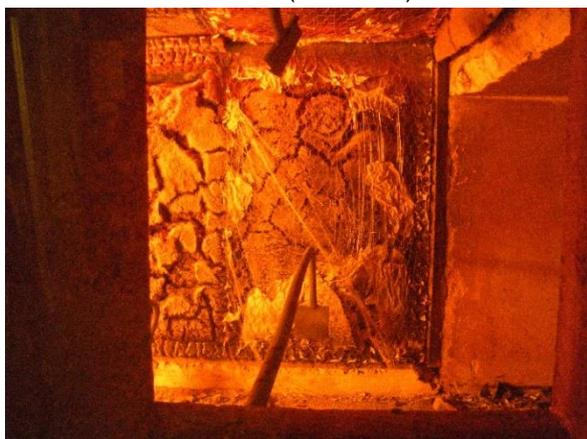
Abbildung 251: Bauchen des Hasendrahtes im Gefach 2 der Wand (10. Minute)
