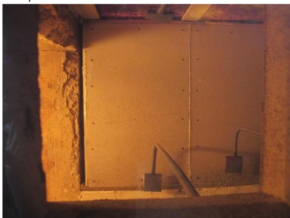
Abbildung 229: Rissbildung in den Gipsplatten der Wand (8. Minute)
