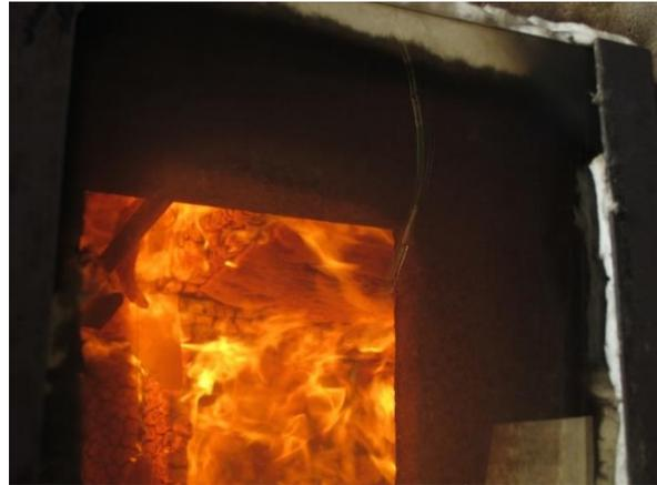
Abbildung 122: Flexirock Decke G2 hält, wölbt sich stark (31. Minute) Versuchsabbruch
