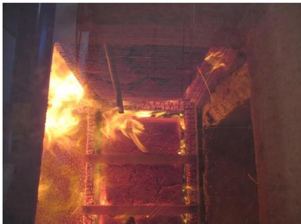
Abbildung 100: Kippen der Dämmung im oberen Bereich des Gefaches 2 der Wand (11. Minute)
