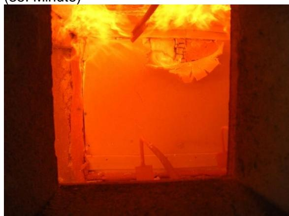
Abbildung 340: Versagen der GKF Wand (40. Minute)
