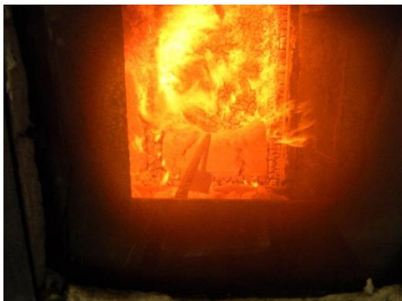
Abbildung 144: Dämmung Wand G2 zum großen Teil herausgefallen (35. Minute)
