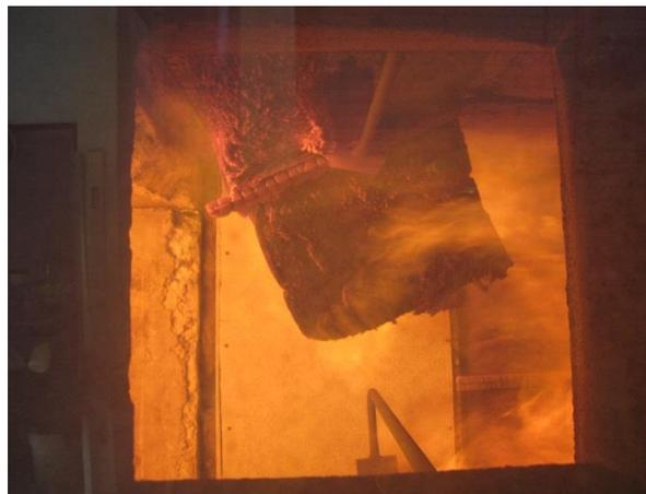
Abbildung 116: Lattung versagt an der Decke G1, Durchzündungen hinter der Dämmung (11. Minute)
