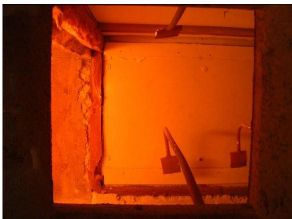
Abbildung 318: Brennen in den Fugen zur Wand (23. Minute)
