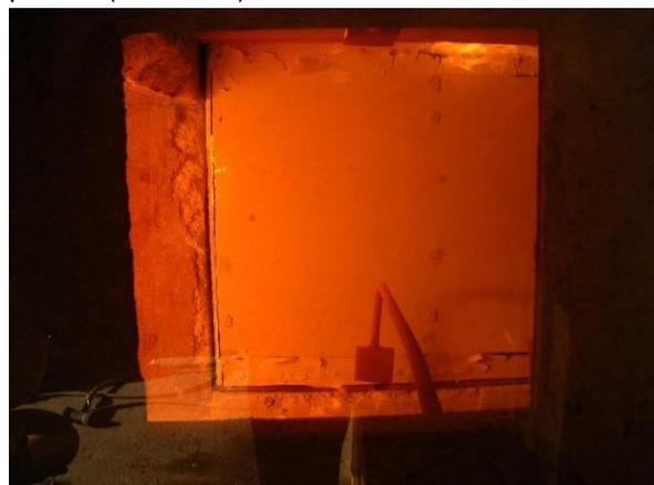
Abbildung 302: Brennen am oberen Rahmen der Wand (26. Minute)
