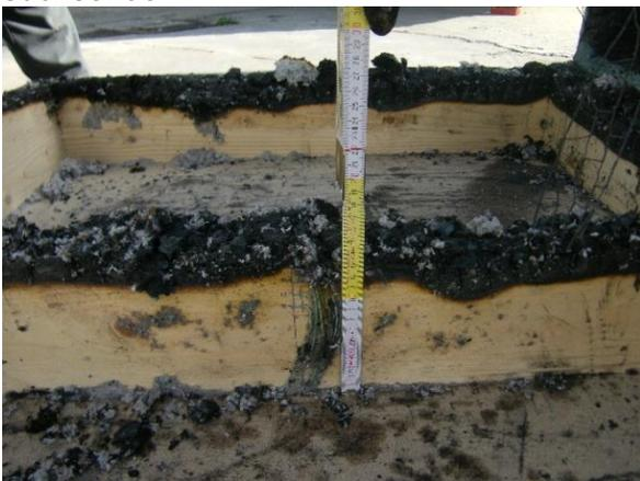
Abbildung 324: Rest des Wandquerschnitts nach ca. 45 Minuten Versuchsdauer
