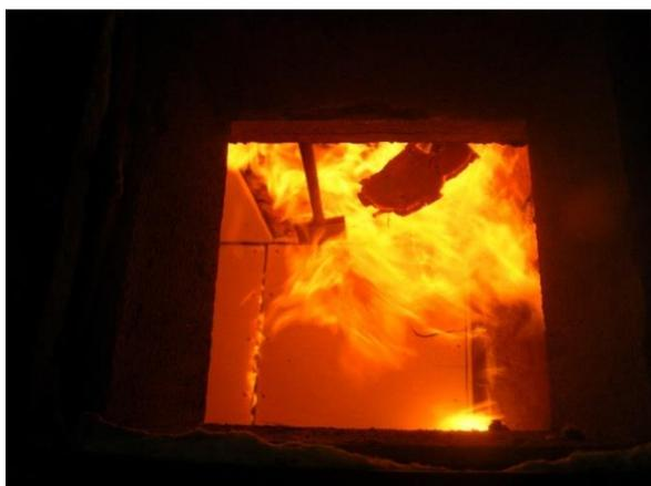
Abbildung 278: Abfallen der Massivholzplatte an der Decke Gefach 2 ( 25. Minute)
