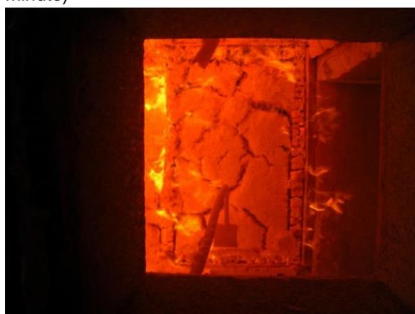
Abbildung 258: Zellulose löst sich vom Ständer an der Wand (Gefach 2) (55. Minute)
