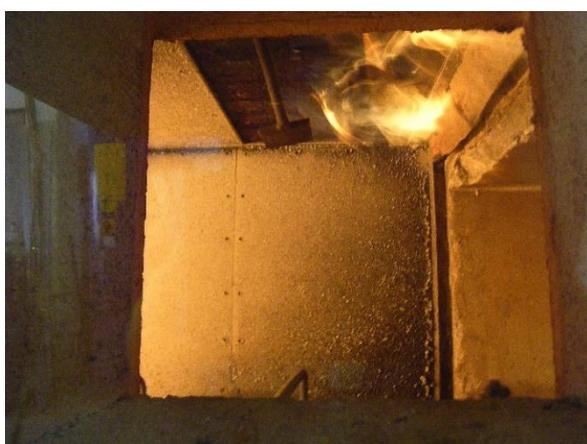
Abbildung 274: Brennen der Massivholzplatte (7. Minute)
