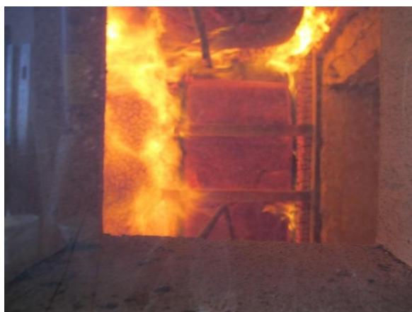
Abbildung 191: starkes Durchhängen der Dämmung im Gefach 2 der Decke und Durchzünden hinter der Dämmung (13. Minute)
