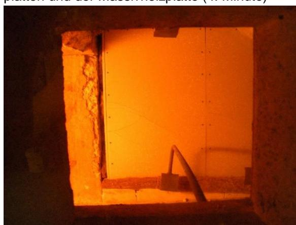
Abbildung 275: Risse in den Gipskartonplatten der Wand (12. Minute)
