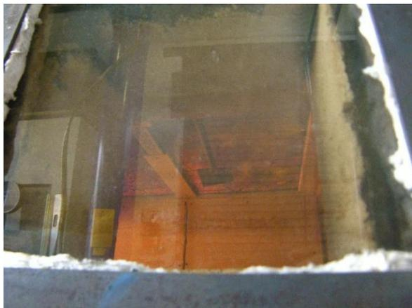
Abbildung 203: Fugen in den Protect-Platten an der Decke öffnen sich (6. Minute)
