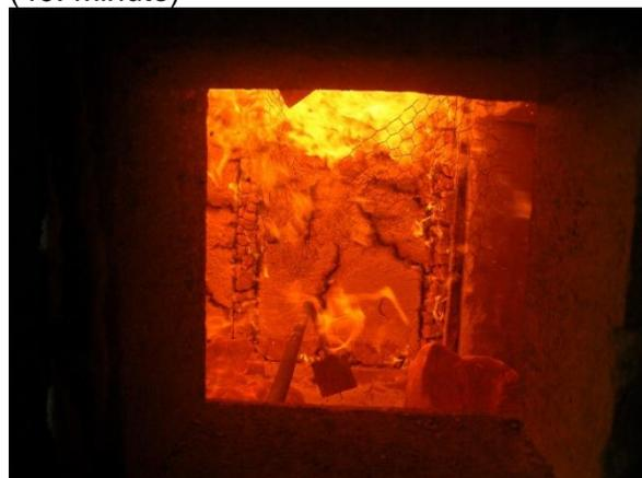
Abbildung 342: Versagen des Hasendrahts und Herausfallen der Dämmung (59. Minute)
