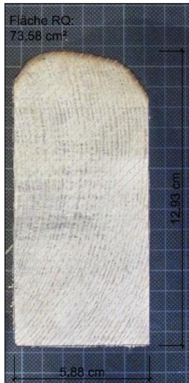
Abbildung 355: Restquerschnitt V11 Wand Mitte
