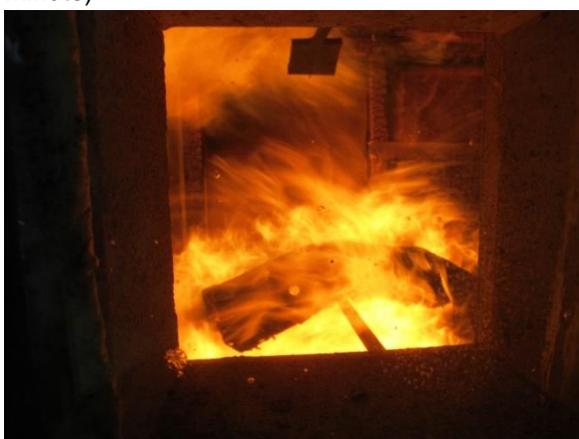
Abbildung 97: Herausfallen der Dämmung aus Gefach 1 der Wand (6. Minute)
