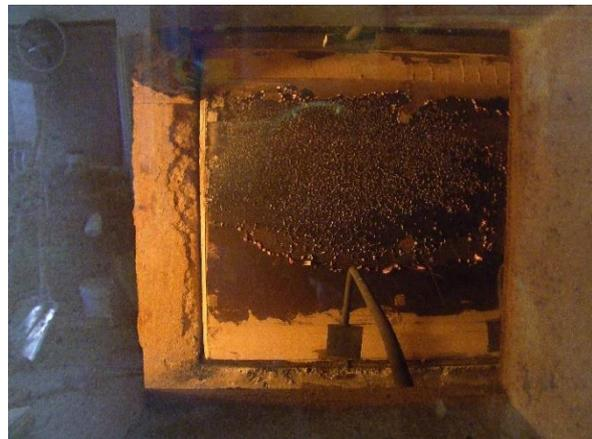
Abbildung 300: Schwarzfärbung der Gipskartonplatten (3. Minute)
