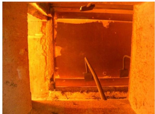
Abbildung 317: Schwarzfärbung der Gipskartonplatten (2. Minute)
