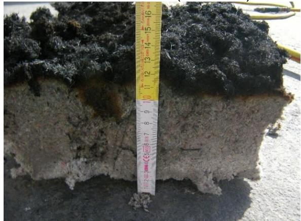
Abbildung 323: Rest der Zellulose nach ca. 45 Minuten Versuchsdauer
