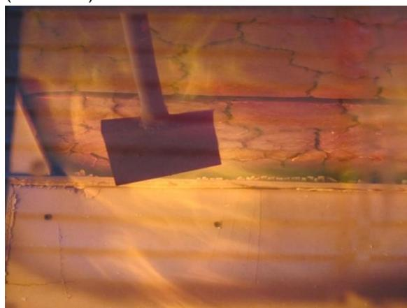
Abbildung 230: Öffnen der Fuge in den Protect-Platten der Decke hier Gefach 2 (9. Minute)
