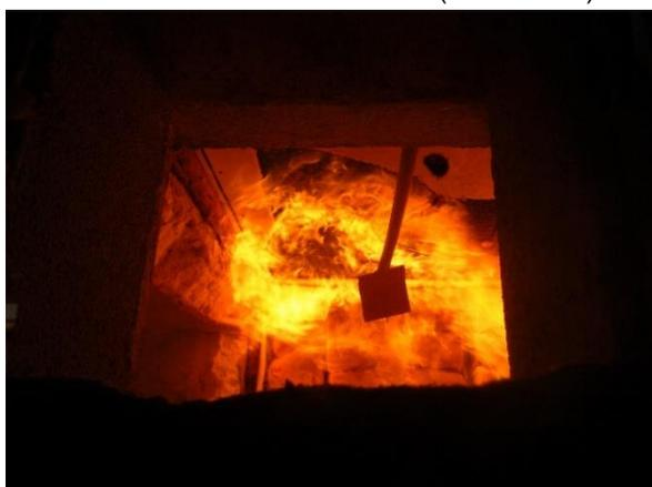
Abbildung 282: Abfallen der Gipsplatte an der Decke im Gefach 1 (33. Minute)
