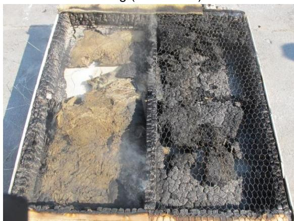
Abbildung 103: Versuchskörper Decke nach Versuchsende
