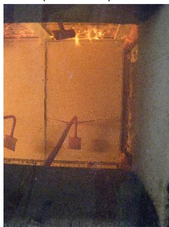
Abbildung 206: vergrößerter Riss in der Wand Gefach 2 (16. Minute)
