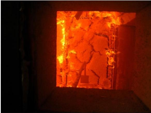
Abbildung 259: Brennen am oberen Rahmen der Wand (Gefach 2) (63. Minute)
