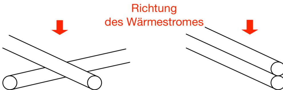
Abbildung 4-15: mögliche Anordnungen der Wärmebrücken zwischen Holzfasern innerhalb eines Dämmstoffes nach Kollmann & Malmquist [33]
