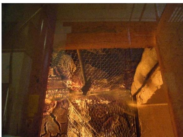
Abbildung 249: Bauchen des Hasendrahtes an der Decke im Gefach 2 (4. Minute)
