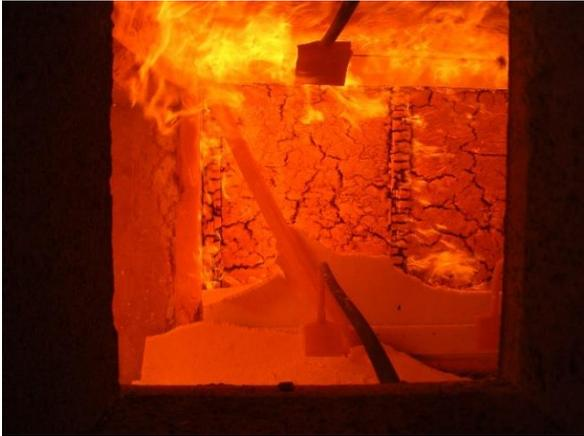
Abbildung 320: Abfallend der GFK-Platten an Decke und (34. Minute)
