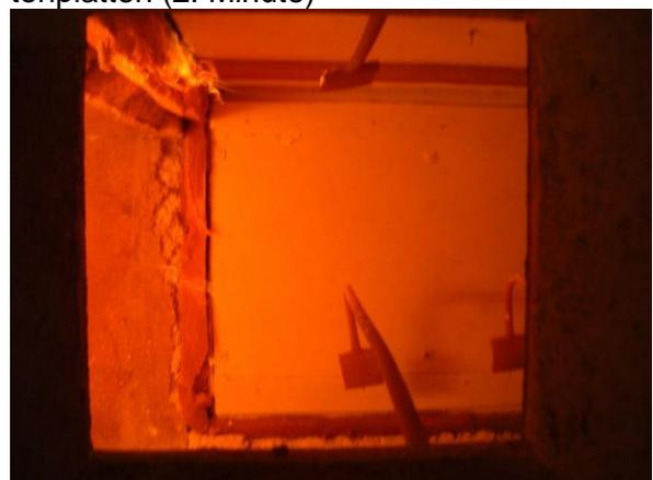
Abbildung 319: Brennen am oberen Rahmen der Wand (28. Minute)
