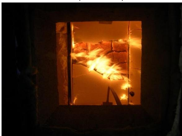
Abbildung 280: Öffnen der Fuge in der Protect-Platte an der Wand im Gefach 1 (27. Minute)
