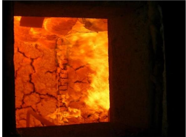
Abbildung 321: Abfallen der Holzfasermatte von Decke in Hasendraht (41 Minute)
