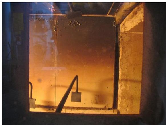
Abbildung 228: Schwarzfärbung der Gipsplatte (3. Minute)
