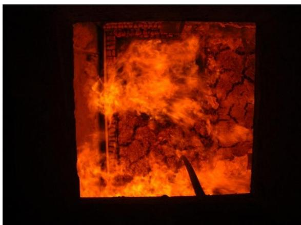
Abbildung 253: Dämmung in der Wand (Gefach 1) zum Teil herausgefallen, Spanplatte dahinter brennt (15. Minute)
