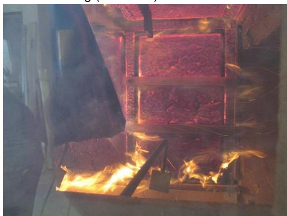
Abbildung 185: Herausfallen der Decke 1 und starkes Schrumpfen der Holzwolledämmung (2. Minute)
