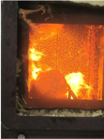
Abbildung 121: Dämmung Wand G1 herausgefallen (28. Minute)
