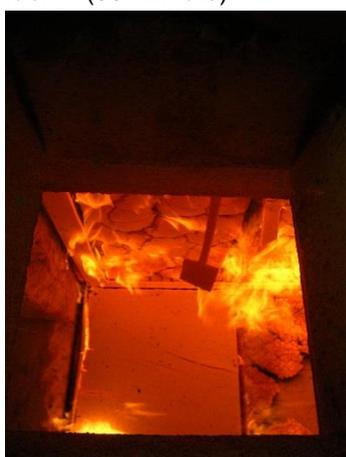
Abbildung 213: Rückzug der Protect-Platten vom Rahmen in der Decke (45. Minute)
