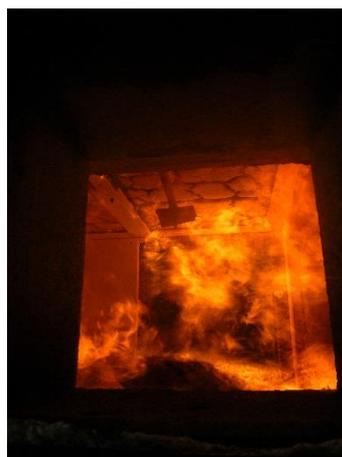
Abbildung 210: Herausfallen der Holzweichfaserdämmung in der Wand Gefach 2 (26. Minute)
