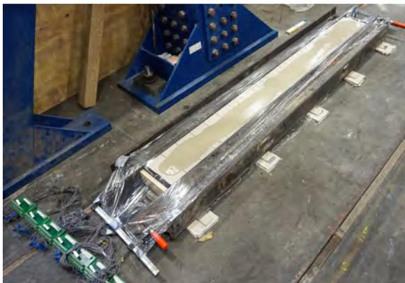
(c) Aufgießen des Vergussmörtels zwischen Holz- und Stahlbauteil
