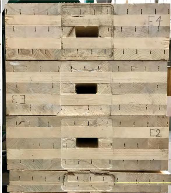
(b) Bruchbilder der Holzversuchskörper
