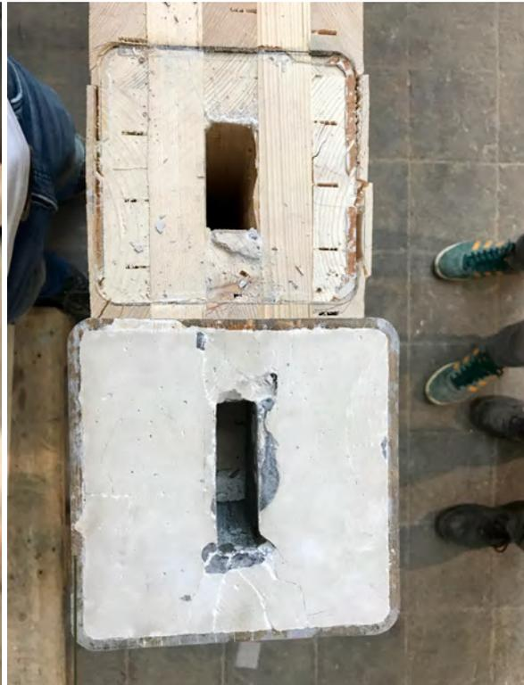
(d) Bruchbild der Hybridankerplatte und des Holzes
