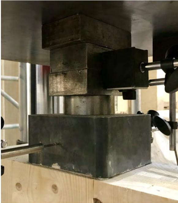
(a) Wegaufnehmer zur Messung der Querverformung der Ankerplatte
