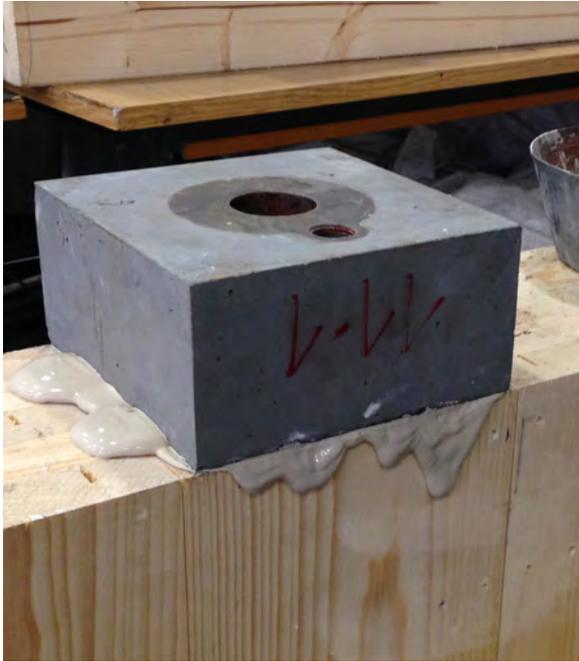
(a) Anordnung der Lasteinleitungsplatte mit Gips-schicht
