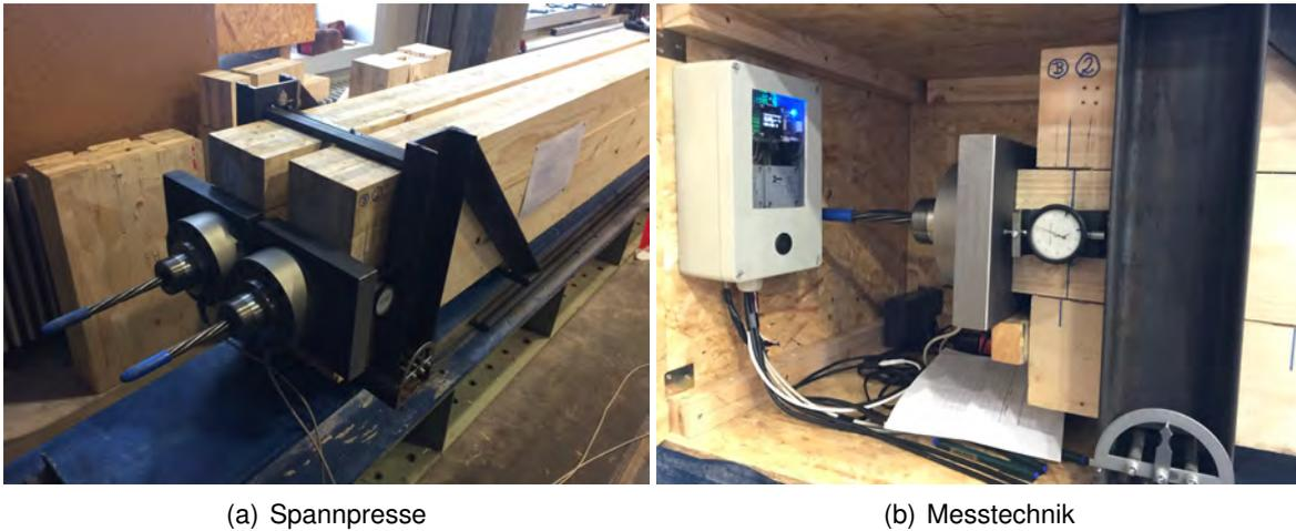
**Abbildung 4.10:** Spannpresse mit Spannkeilgehäuse (a), Anordnung der Messeinrichtungen (b)
