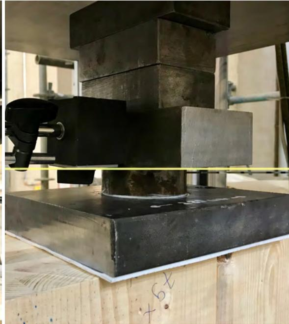
(b) Stahlplatte mit Teflonunterlage
