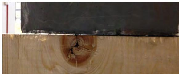
(c) Spalt zwischen Lasteinleitungsplatte und Holz
