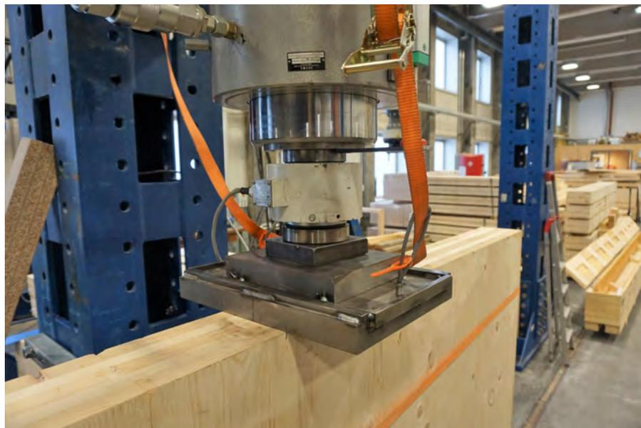
**Abbildung 3.21:** Lasteinleitungsplatte und Hydraulikzylinder an der Oberkante des BSP-Prüfkörpers
