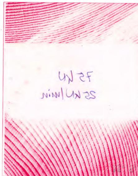
**Abbildung 3.15:** Messergebnis einer Druckmessfolie unter einem dreischichtigen Brettsperrholzprobekörper. Gut sichtbar wird die Kraftübertragung über die Hirnholzflächen und der Abdruck der Jahrringe.
