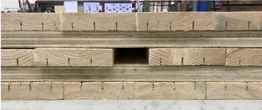
**Abbildung 2.8:** Ansicht des Lagenaufbaus mit Spannkanal
