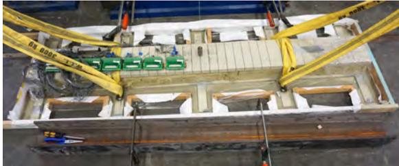
(a) Einheben des Messbauteils in das Mörtelbett auf dem Hallenboden
