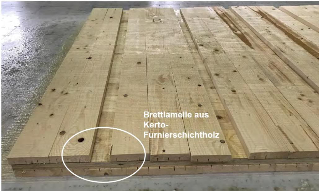
**Abbildung 2.6:** Spannkanal in der Mittellage, Aufbau mit Verstärkung aus KERTO Furnierschichtholz
