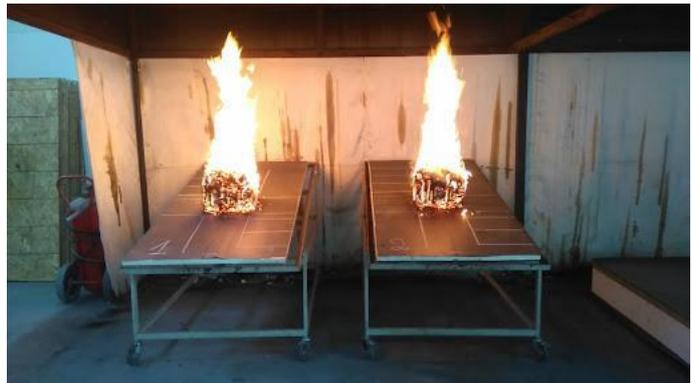
Die Arbeits- und Forschungsschwerpunkte sind die Planung von Brandversuchen und die Herstellung von Prüfkörpern zur *Untersuchung des Brandverhaltens von PV-Dachanlagen auf Dächern im Bereich von Brandwänden*
