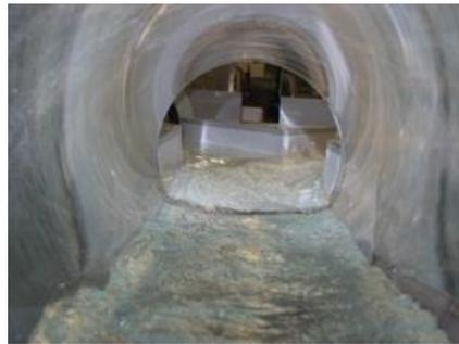
Untersuchung der Strömung und der Möglichkeit von Sedimentablagerungen in einem Abwasserkanal (2005).
