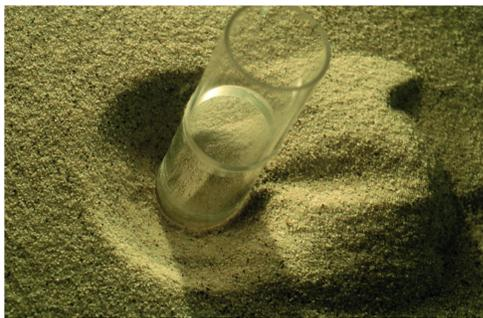
Auskolkung um einen zylindrischen Brückenpfeiler in sandigem Bett. Das Foto entstand während eines Modellversuchs im Hydromechaniklabor (Pfeifer et al., Int. Conf. Scour & Erosion, 2011).
