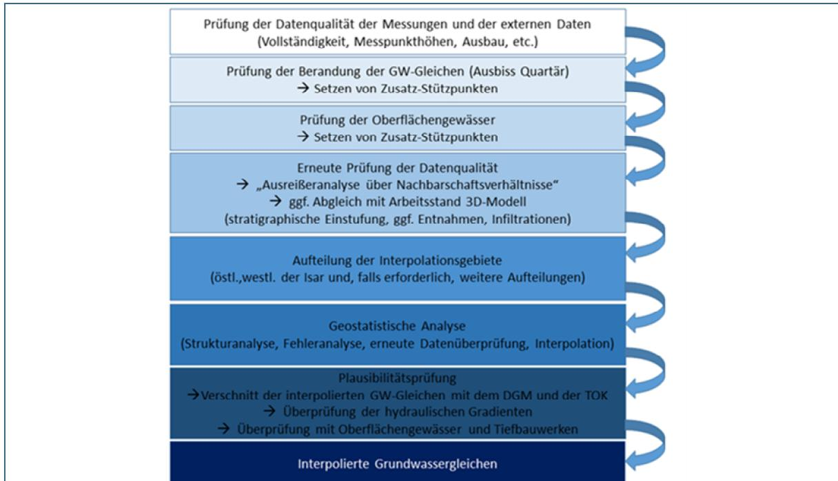
Abb. 12: Zusammenfassung der Methodik zur Erstellung des Grundwassergleichenplans.
