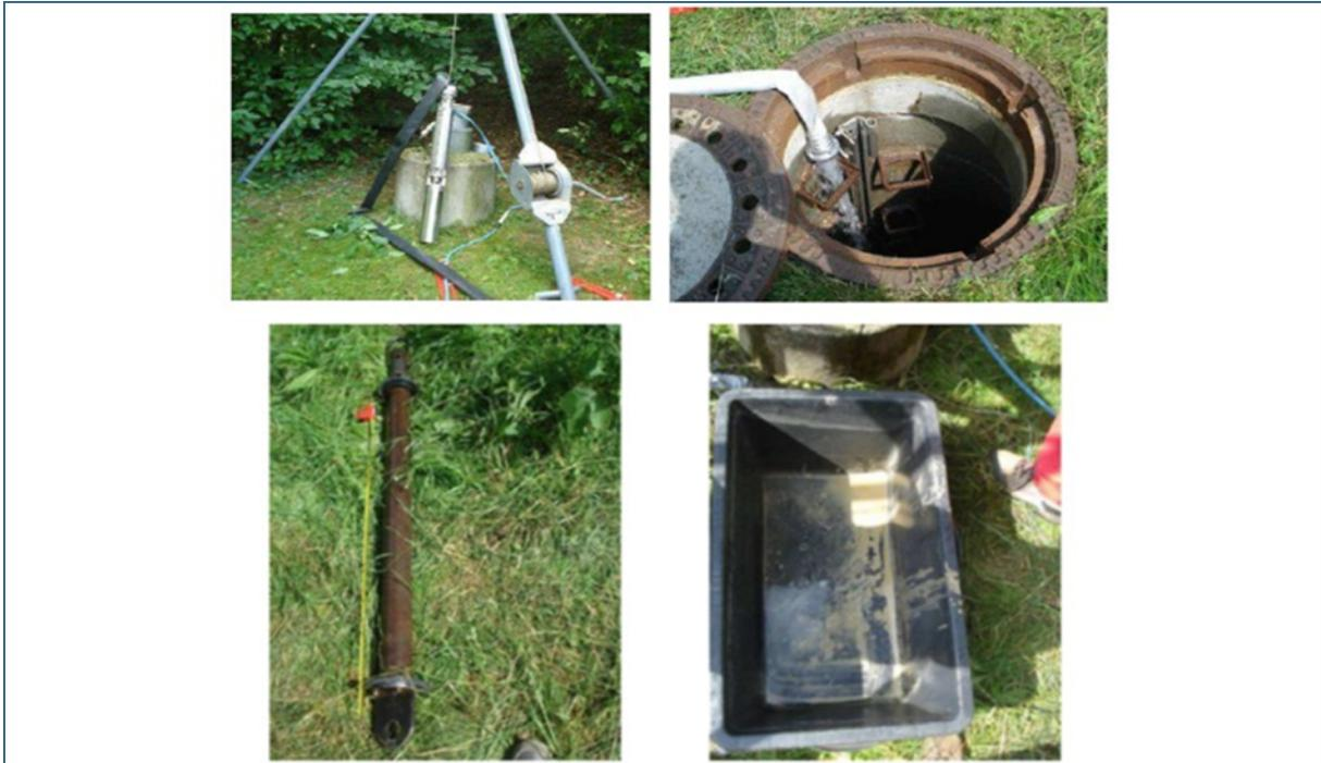
Abb. 14: Durchführung eines Pumpversuchs im Untersuchungsgebiet: Einbau der Pumpe, Ableitung in den Kanal der Münchner Stadtentwässerung, Kolben und Sedimentrückstand nach der Kolbung.
