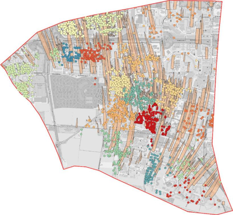
Abbildung 38: Clustering von Förderbrunnen mit dem eingeschränkten k-means-Algorithmus
